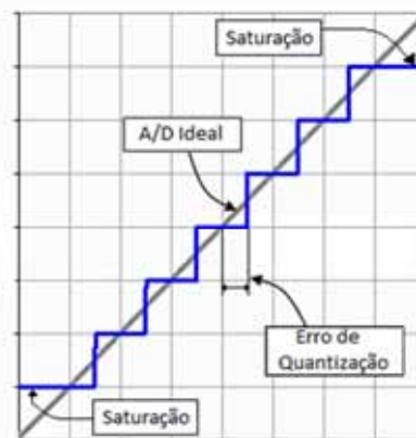
Figura 2.13 - Erro de quantização e saturação de um conversor AD
