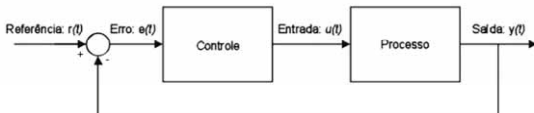
Figura 2.3 - Diagrama de blocos de um sistema de controle a malha fechada
