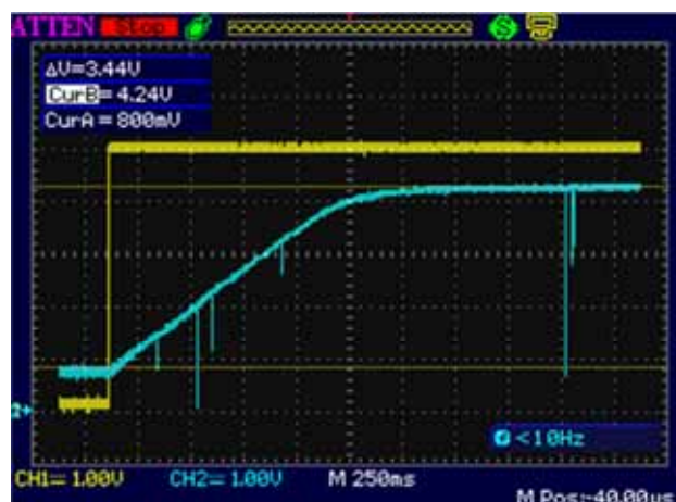
Figura 7.9 - Resposta do sistema para K_p = 10 / K_d = 1,2 / K_i = 0,5
