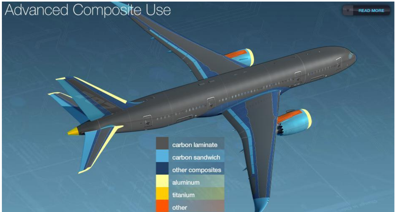
Figura 1: Distribuição de materiais no Boeing 787.
