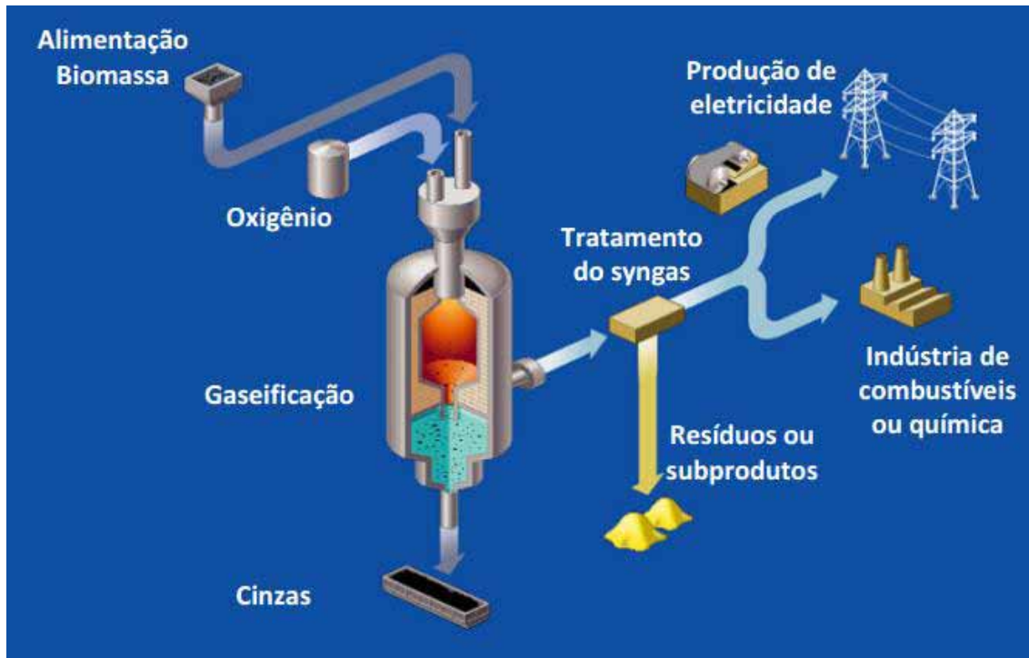
Figura 3: Processo termoquímico para conversão de biomassa ou outro combustível sólido em gás de síntese
