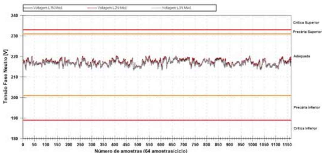
Figura 33 – Perfil de tensões eficazes de fase, quadro QDCA-1 para análise em regime permanente, período de monitoramento 01/07 – 09/07.
