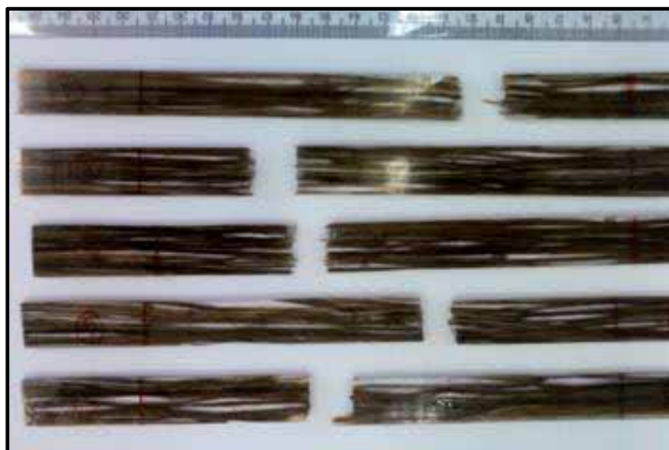
Figura 17 – Corpos de prova do compósito epóxi/sapê 10% NaOH após ensaio de tração.
