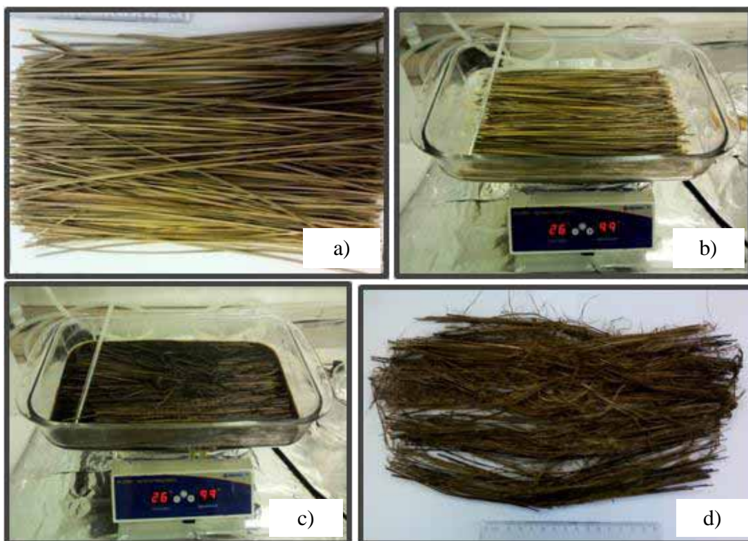
Figura 3 – Etapas do tratamento alcalino: a) fibras selecionadas; b) início do tratamento; c) após 1 hora de tratamento; d) após secagem das fibras em estufa.
