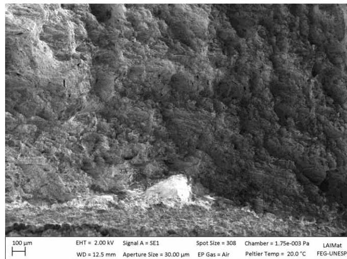
Figura 44 : Análise Metalográfica MEV – Zona de Estiramento – Ampliação de 100x e 1000x respectivamente.
