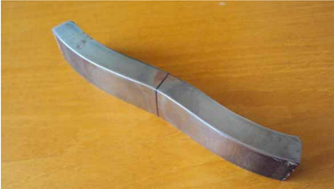
FIGURA 16: Corpo-de-prova com linha de solda revelada e marcada.
