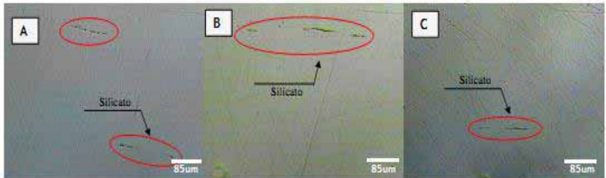
Figura 29: Corte Longitudinal da Linha de Solda. Inclusão, sem ataque, 100x [A, B e C].
