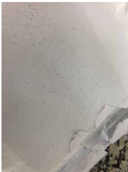
Figura 13 - Manta de PSU/DMAc e CNTs com concentração de 24% e 0,1% CNTs
