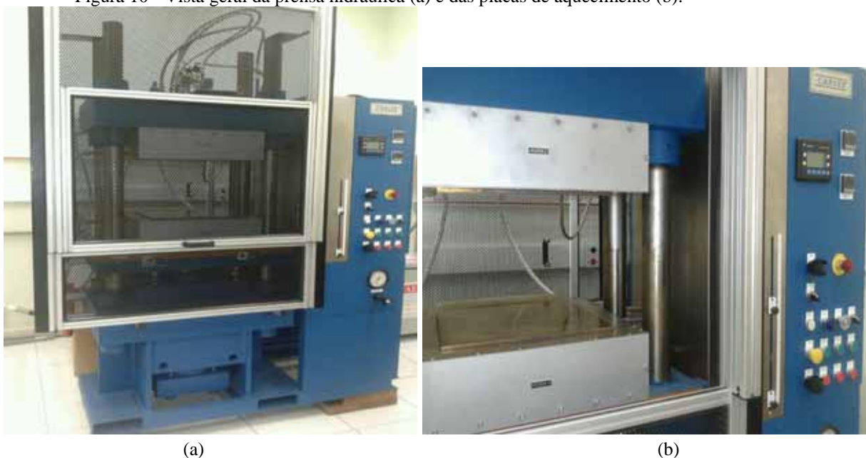
Figura 10 - Vista geral da prensa hidráulica (a) e das placas de aquecimento (b).
