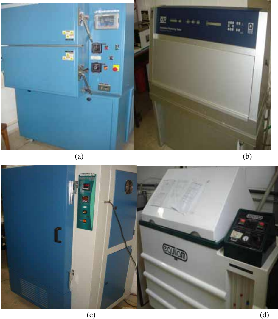
Figura 11 - Equipamentos dos condicionamentos ambientais: (a) câmara de choque térmico; (b) câmara de UV; (c) câmara do condicionamento higrotérmico; (d) câmara de névoa salina.
