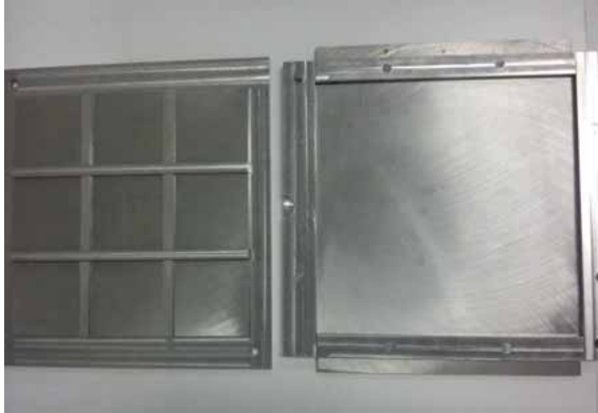
Figura 9 - Parte inferior e superior do molde usado na prensa.
