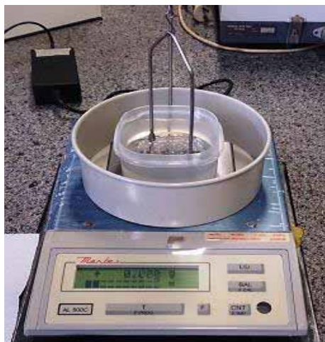
Figura 32 – Dispositivo de Arquimedes (balança hidrostática)
