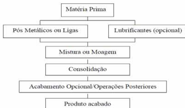
Figura 09 – Fluxograma simplificado das etapas para produção de peças por metalurgia do pó.
