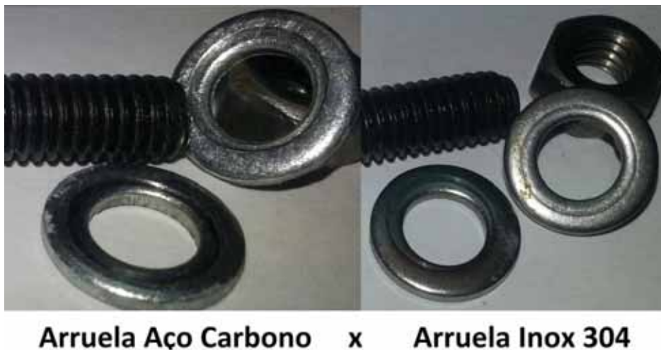
Figura 13- Comparação de deformação das arruelas de aço carbono e inox 304 no ensaio desse estudo.
