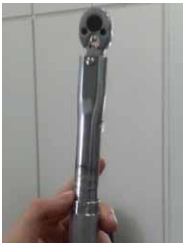
Figura 7 – Torquímetro Utilizado nos ensaios.
