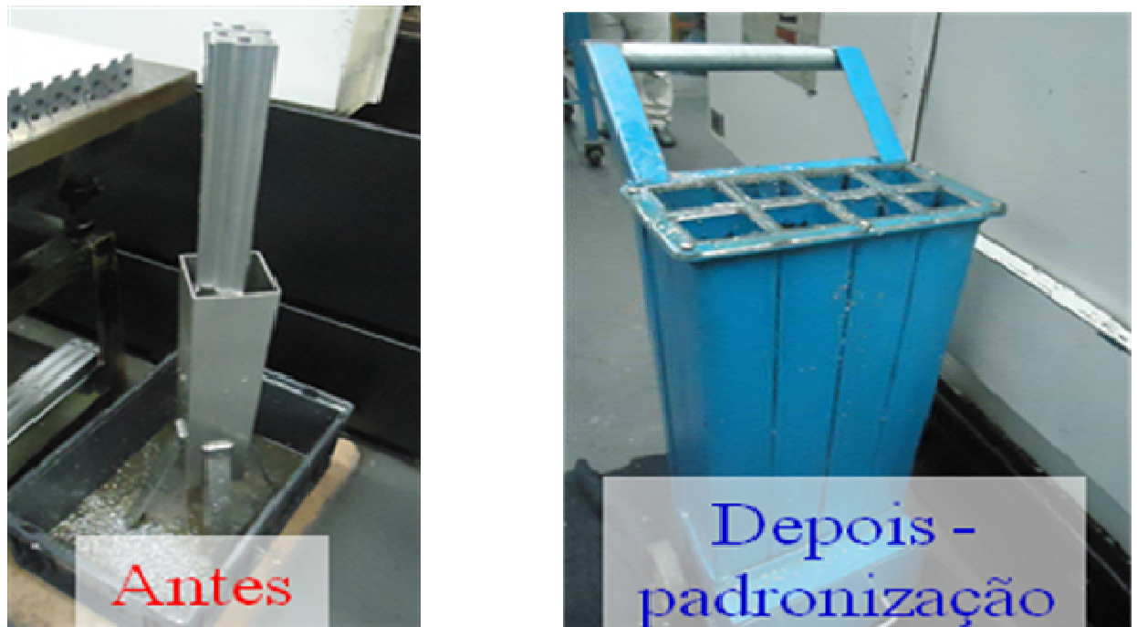
Figura 12 - Fotografia do suporte para escorrer óleo refrigerante
