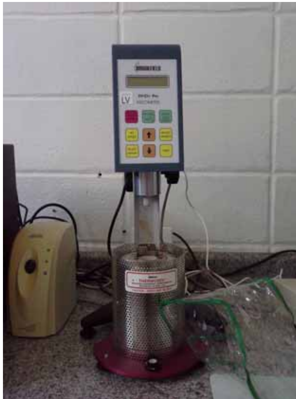
Figura 6 – Viscosímetro Brookfield utilizado nas análises de viscosidade.
