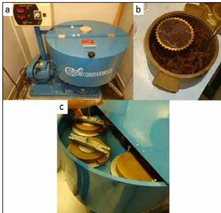
Figura 11. Refino da celulose; a) moinho centrífugo Jokro Mühle - REGEMED-MJ/K6; b) celulose sendo preparada na panela de refino; c) panelas sendo anexadas no moinho.
