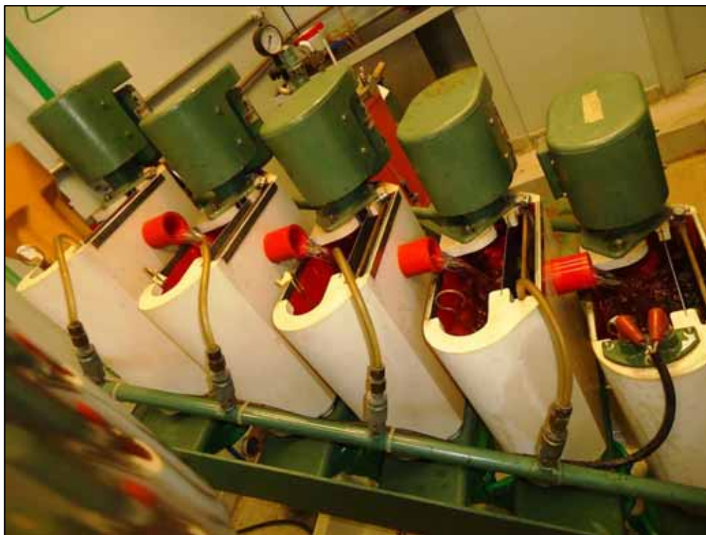
Figura 10. Classificador de fibras em Bauer McNett, constituída por cinco tanques em cascatas, equipado com peneiras em cada um dos compartimentos e água corrente para a passagem das fibras.
