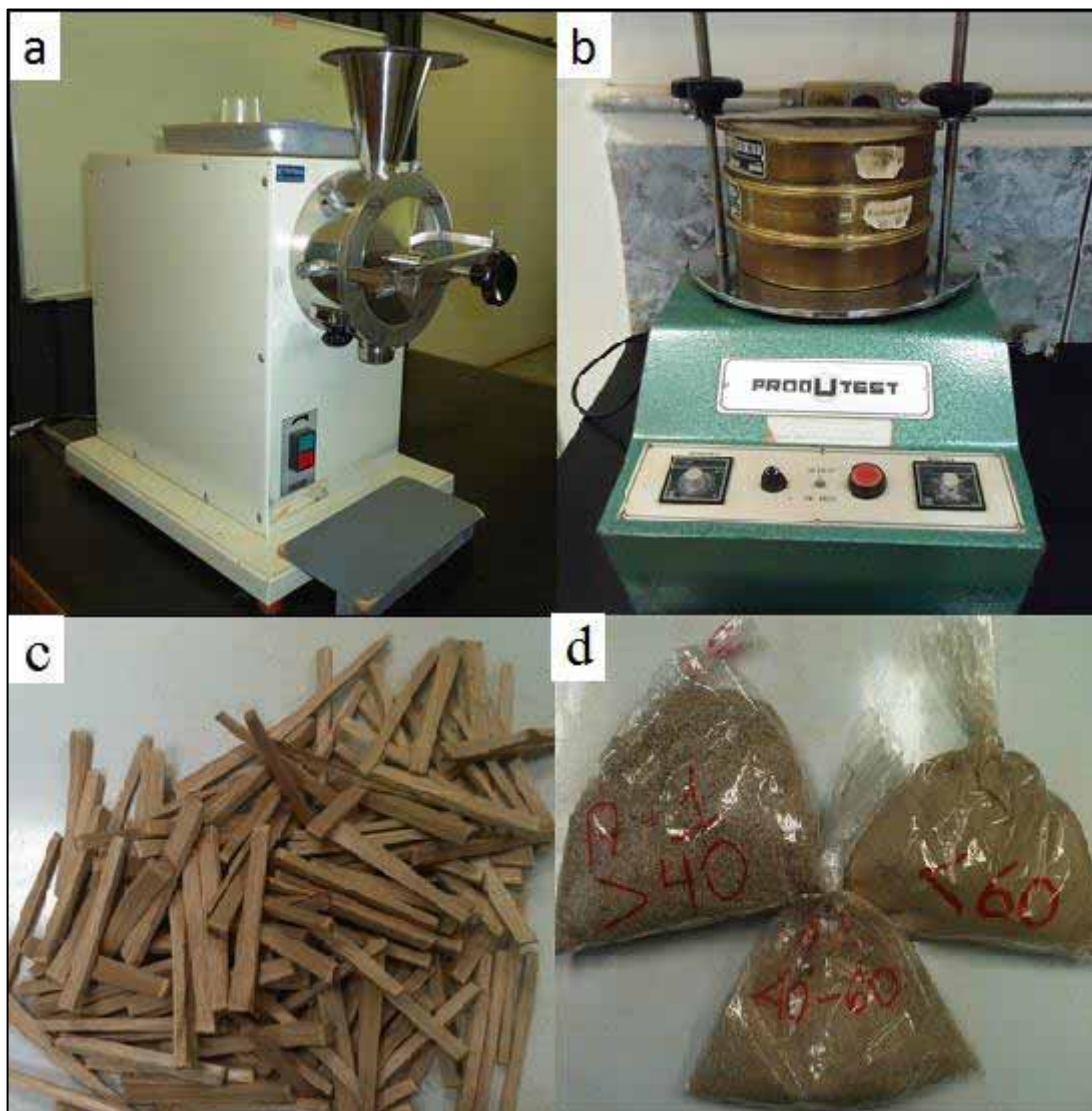
Figura 6. Preparo de amostras para análise da composição química da madeira; a) macro-moinho Wiley para transformar palitos de madeira em serragem; b) peneiras classificatórias de serragem para obtenção da fração 40/60 Mesh; c) palitos de madeira a serem reduzidos a serragem; d) serragem classificada.
