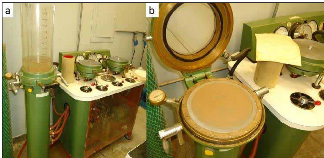
Figura 13. Formação do papel; a) máquina formadora de papel tipo Köthen rapid - REGMED-F/SS-2; b) papel de celulose marrom de Cecropia palmata sendo formada.
