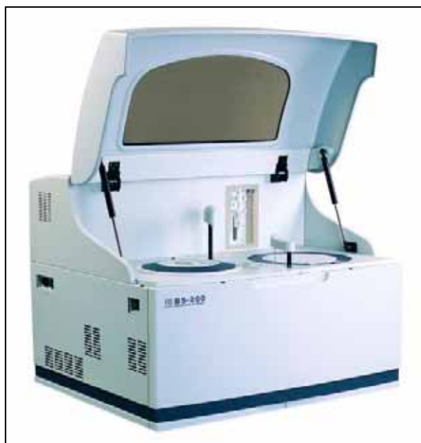
Figura 5 - Analisador bioquímico da FMB/UNESP - UNIPEX – BIOQUÍMICA. Analisador bioquímico automatizado BS-200 (Mindray Medical International Limited, China) - dosagem da creatinina sérica.
