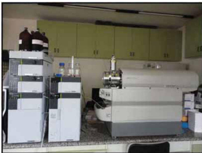
Figura 6 - Cromatógrafo Líquido (Proeminence UFLC) acoplado ao espectrômetro de massas (3200 Q TRAP) – LC-MS/MS. Botucatu/SP – NUPAM, Campus do Lageado, 2013.
