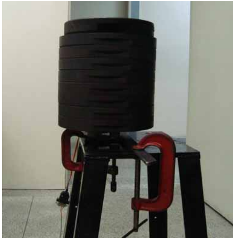
Figura 21 – Imagem do procedimento da calibração da célula de carga de 700 N. Fase de carregamento (10º ponto)
