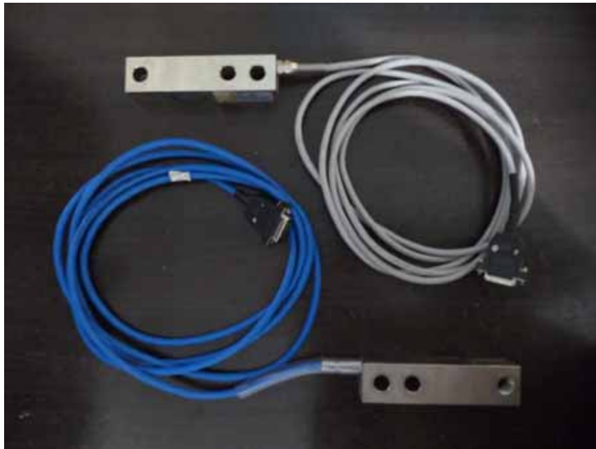
Figura 11 – Imagem das células de carga de 5000 N e 2500 N utilizados no experimento
