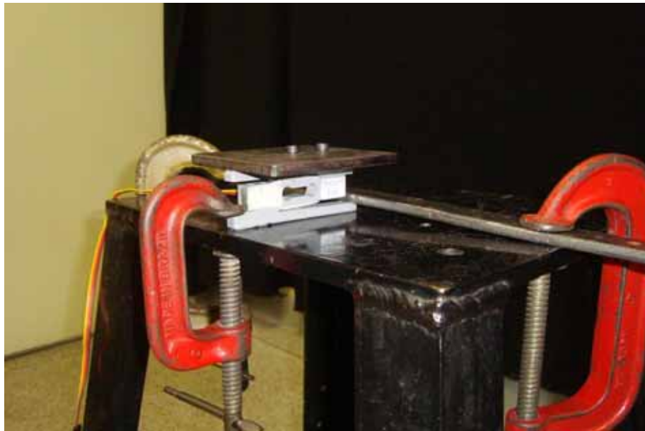
Figura 20 – Imagem da montagem para a calibração da célula de carga de 700 N
