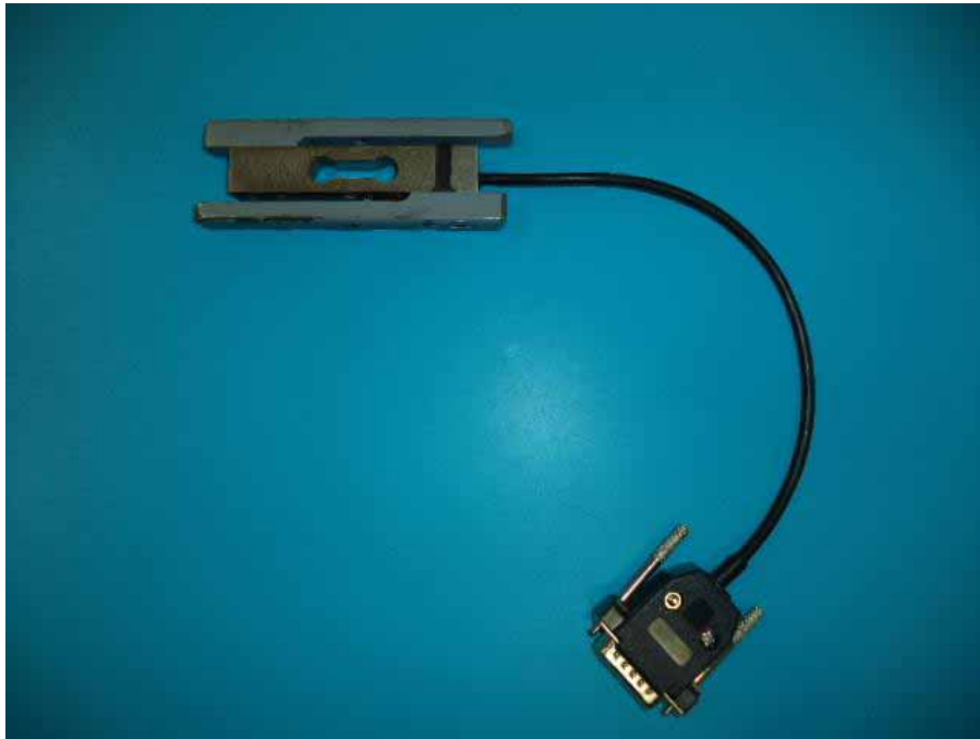
Figura 12 – Imagem da célula de carga de 700 N confeccionado para o experimento
