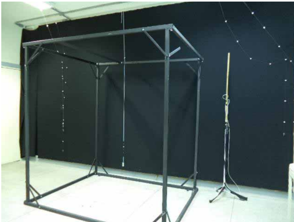
Figura 13 – Imagem da estrutura metálica para suporte do instrumento
