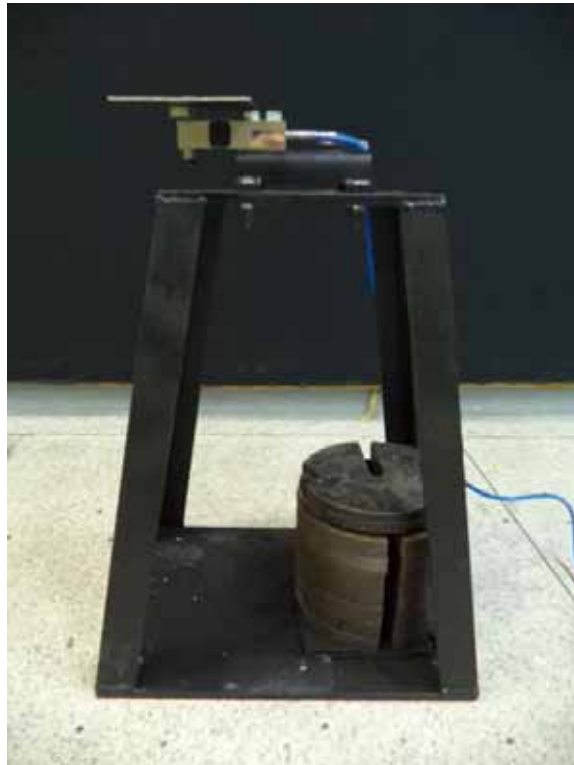
Figura 18 – Imagem da montagem para a calibração da célula de carga de 2500 N
