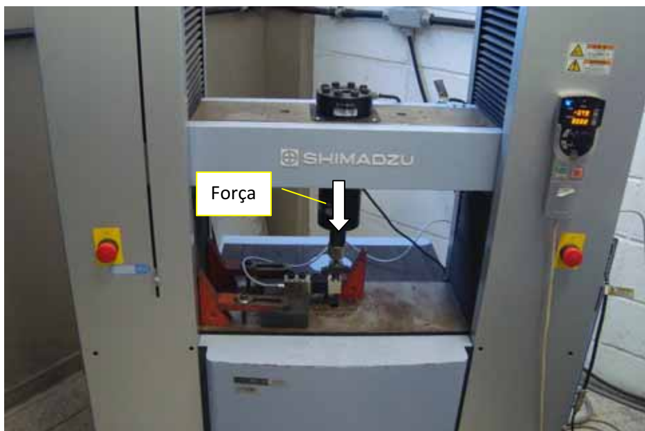
Figura 16 – Imagem da montagem realizada para a calibração da célula de carga de 5000 N
