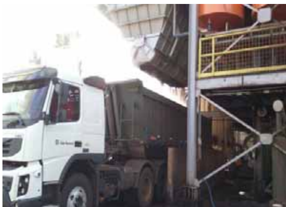
(1) Carregamento da torta de filtro na indústria da usina
