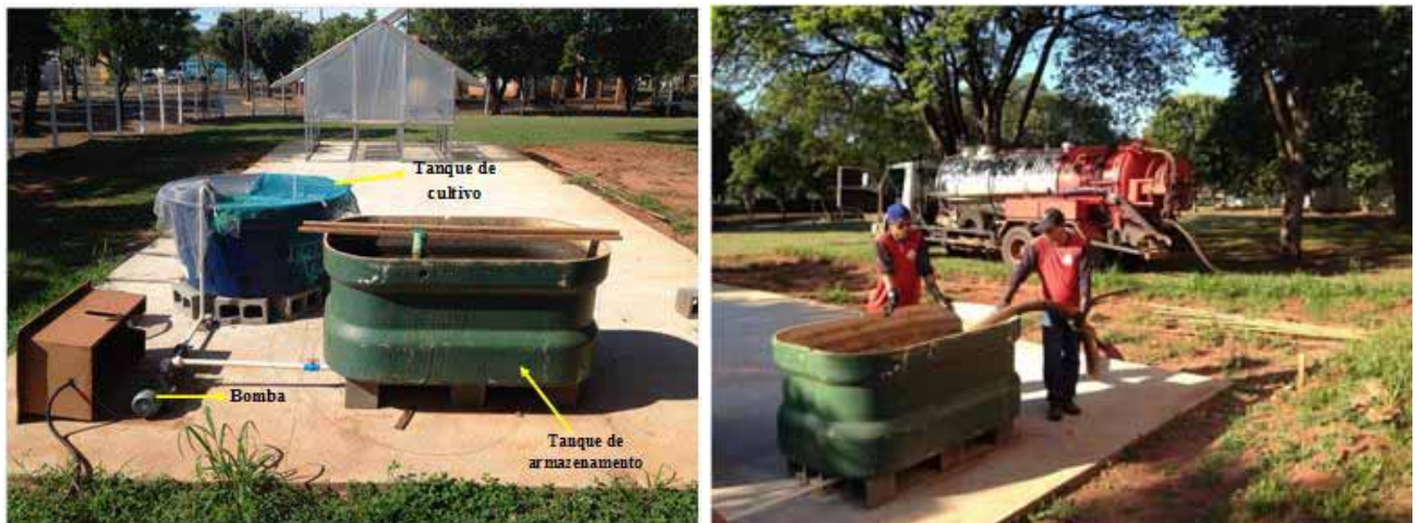
Figura 2- Sistema de tratamento montado em área externa do laboratório (esquerda) e abastecimento do tanque de armazenamento com efluente da ETE de Ilha Solteira (direita).
