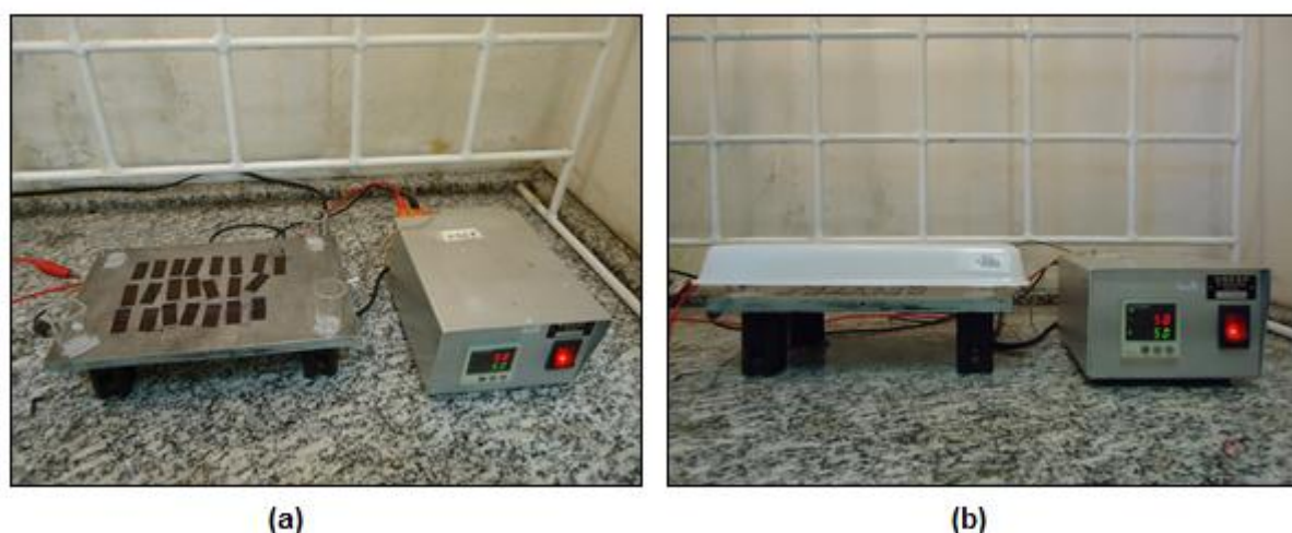
Figura 26: (a) Solução POMA/PMMA depositadas por drop-casting sobre as lâminas dispostas em chapa aquecida a 50 °C. (b) Anteparo posicionado sobre as lâminas permitindo a evaporação do solvente.
