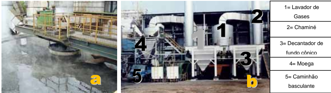
Figura 2.3 – Nas usinas a água suja dos lavadores de gases pode seguir para um decantador (a) onde em seu fundo sai o lodo (cinzas+ fuligem). A Figura 3b apresenta um sistema completo de tratamento de água de fuligem e a saída das cinzas geradas em moegas as quais são dispostas em caminhões para serem transportadas para as lavouras de cana.
