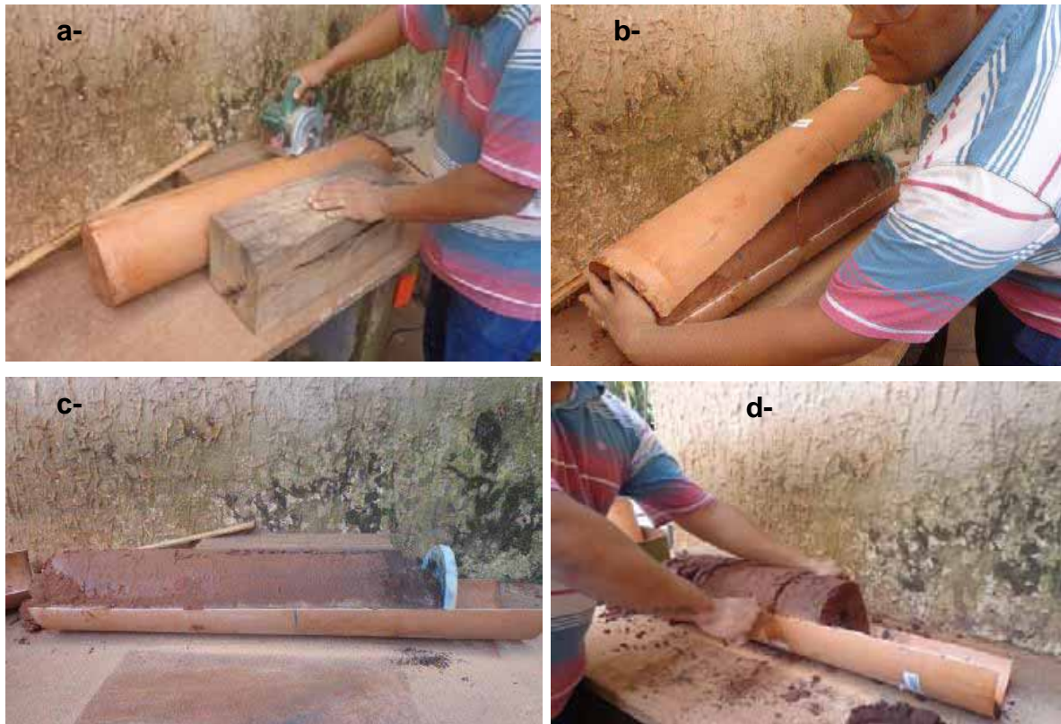
Figura 5.2. - Fotos evidenciando a abertura das colunas indeformadas de solo após 24 semanas do experimento (a), retirada do PVC (b), imagem do solo no interior da coluna (c) e Fracionamento do solo em diferentes profundidades (d).
