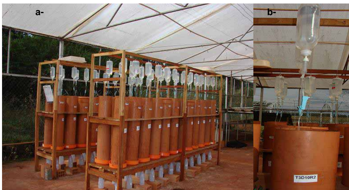
Figura 5.1. - Fotos evidenciando o experimento das colunas indeformadas na casa de vegetação (a) e detalhe do quite de gotejamento (b).
