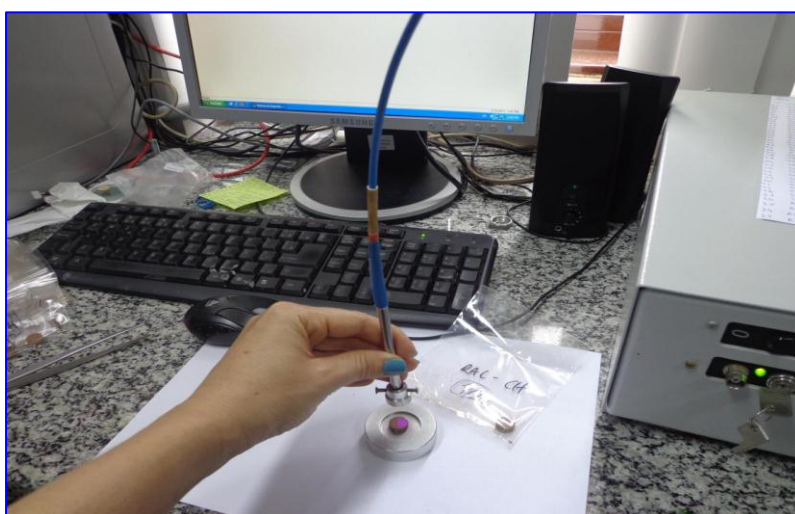
Figura 4. Emissão de Fluorescência Induzida a Laser numa amostra de solo adicionado de cinza de bagaço de cana-de-açúcar.
