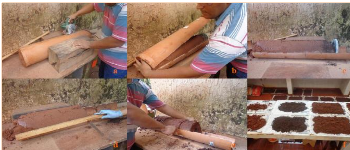
Figura 11. Etapas do fracionamento dos Latossolos das colunas: abertura (a) ; nivelamento (b) ; posicionamento (c) ; separação em camadas de 0,10 m (d) ; corte (e) e secagem (f) .
