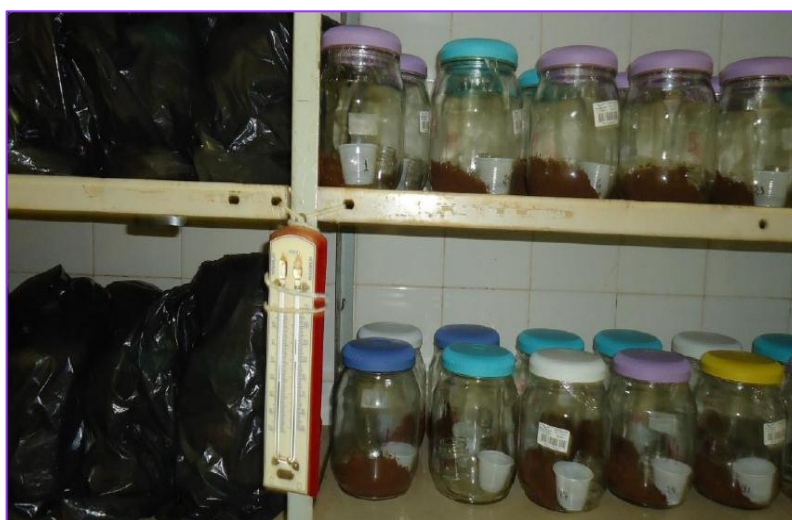
Figura 7. Argissolo adicionado de cinza de bagaço de cana-de-açúcar e incubado na presença de hidróxido de sódio 0,25 mol L -1 sob condições controladas de luminosidade, umidade e temperatura.
