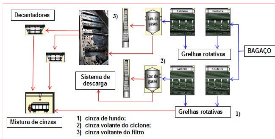
Figura 1. Cinzas de bagaço de cana-de-açúcar produzidas em grelha (adaptado de YIN; ROSENDAHL; KAER, 2008).
