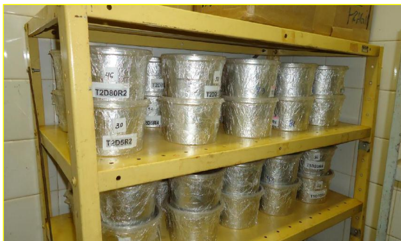
Figura 3. Latossolos de diferentes texturas adicionados de cinza de bagaço de cana-de-açúcar e incubados na presença de NaOH 0,5 \text{ mol L}^{-1} sob condições controladas de luminosidade, umidade e temperatura.
