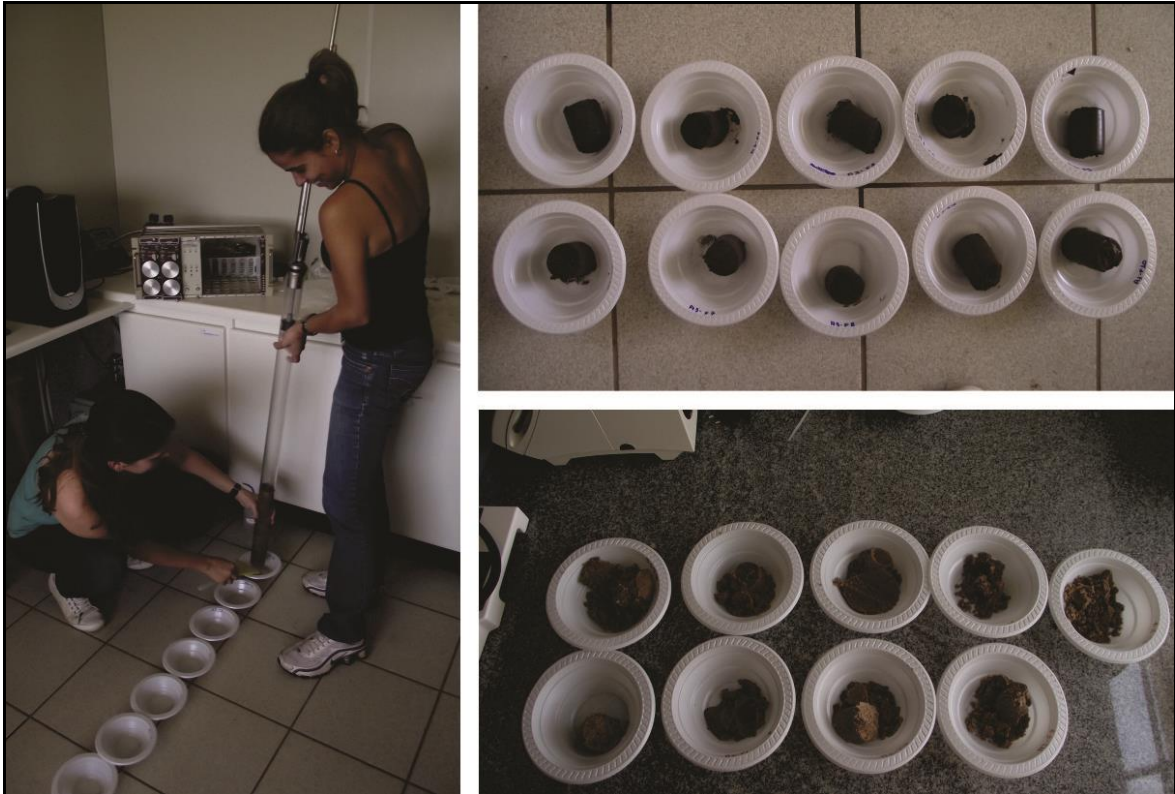
FIGURA 10 – Imagens ilustrativas do procedimento de fatiamento dos perfis de sedimentos coletados em situação de fundo de vale.
