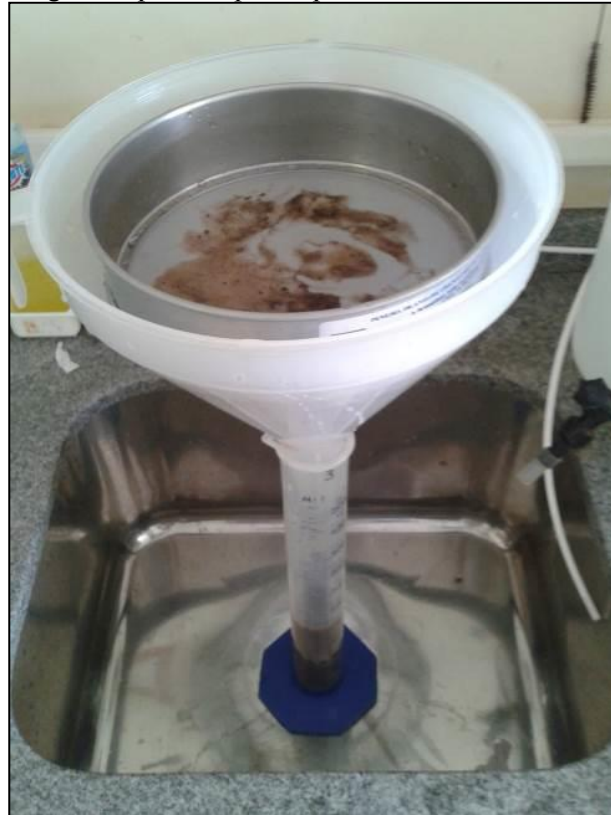
FIGURA 13 – Estrutura composta por proveta, funil e peneira de 0,053mm para transferir o sedimento e dispersante da garrafa plástica para a proveta de 500ml.
