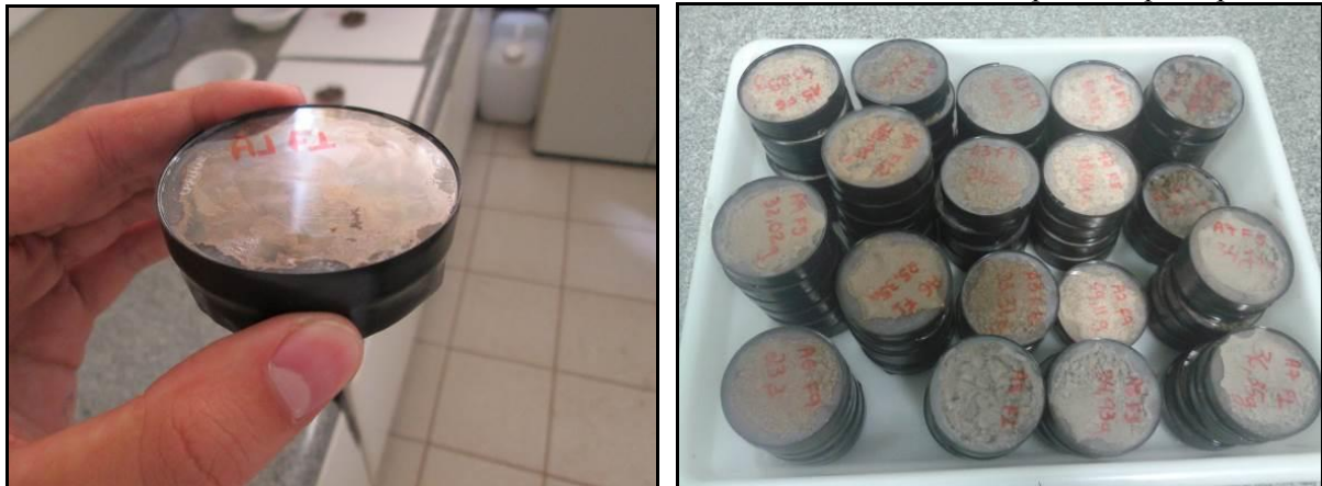
FIGURA 11 – Sedimento das amostras vedadas com silicone e fita isolante em placa de petri plástica.
