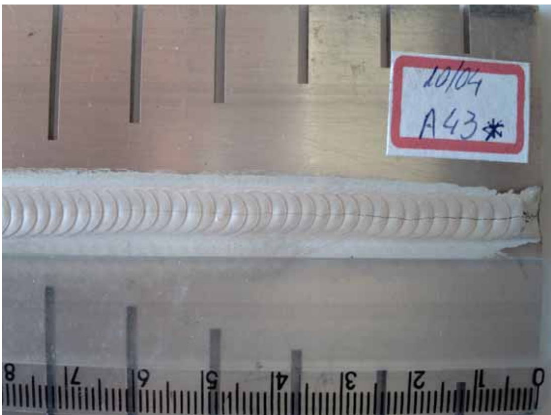
Figura 5.10- Foto da trinca. Frequência de inversão de polaridade de 50Hz e pulso térmico de 1,7Hz.
