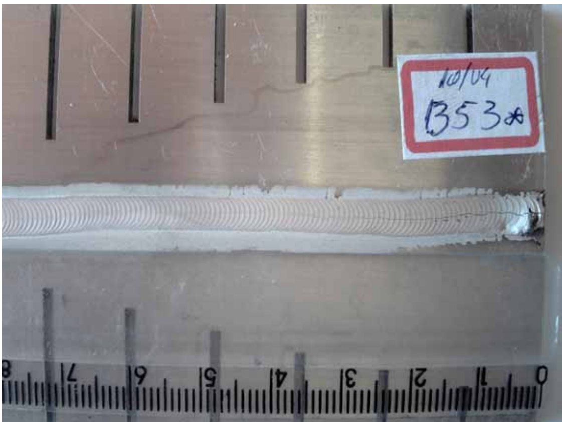
Figura 5.16- Foto da trinca. Frequência de inversão de polaridade de 100Hz e pulso térmico de 5,0Hz.
