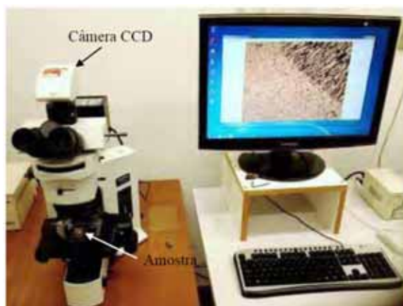
Figura 4.7- Equipamentos e acessórios utilizados para aquisição de imagem microestrutural: microscópio óptico, câmera CCD e microcomputador.
