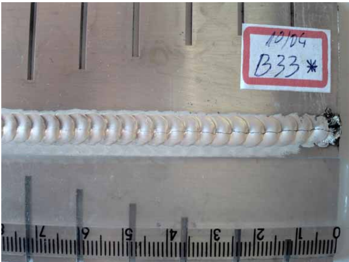
Figura 5.14- Foto da trinca. Frequência de inversão de polaridade de 100Hz e pulso térmico de 1,0Hz.
