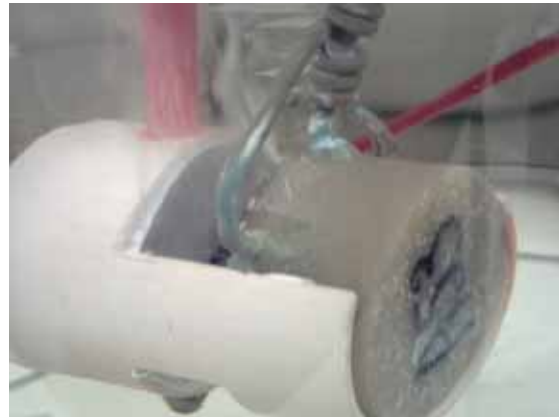
(b) detalhe da anodização mostrando Cátodo e amostra
