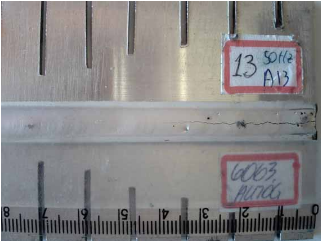
Figura 5.7- Foto da trinca. Freqüência de inversão de polaridade de 50Hz e sem pulso térmico.
