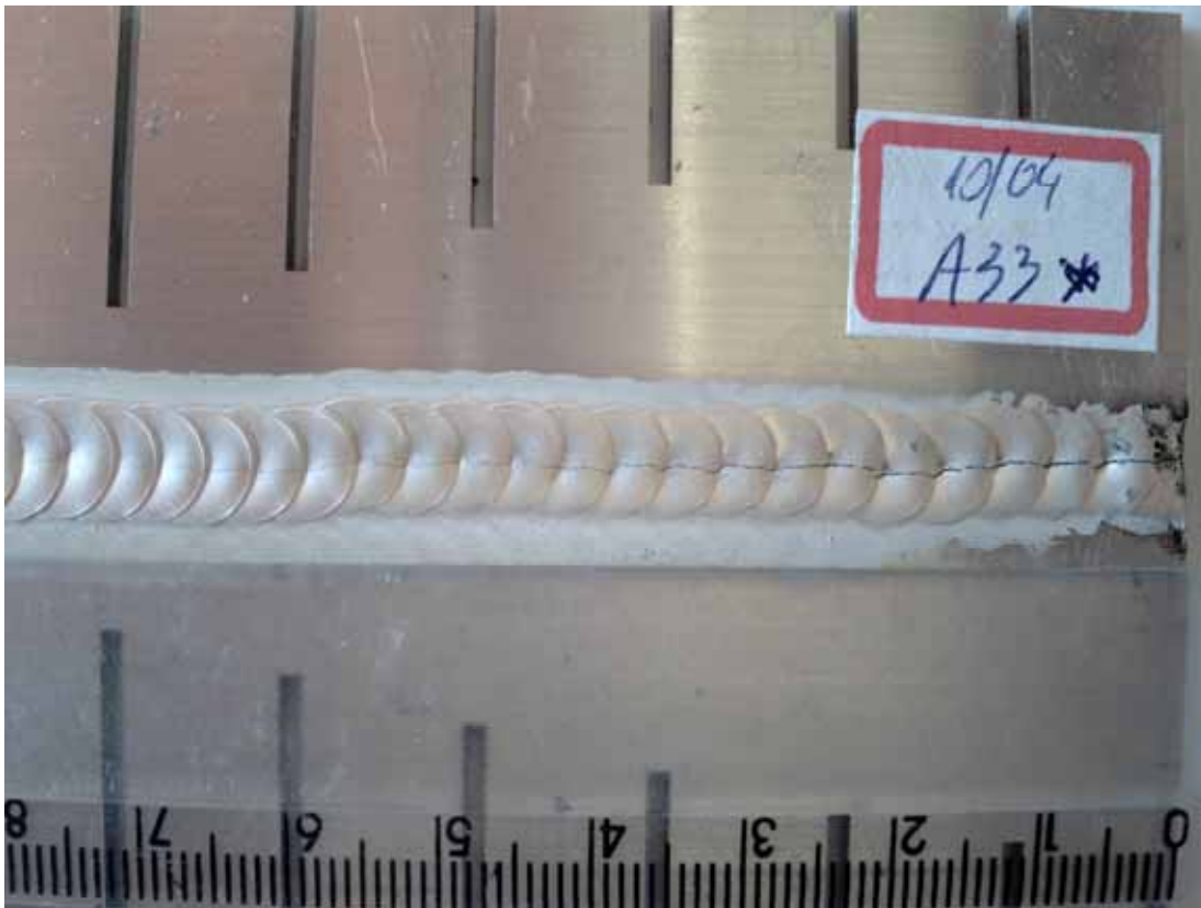
Figura 5.9- Foto da trinca. Frequência de inversão de polaridade de 50Hz e pulso térmico de 1,0Hz.
