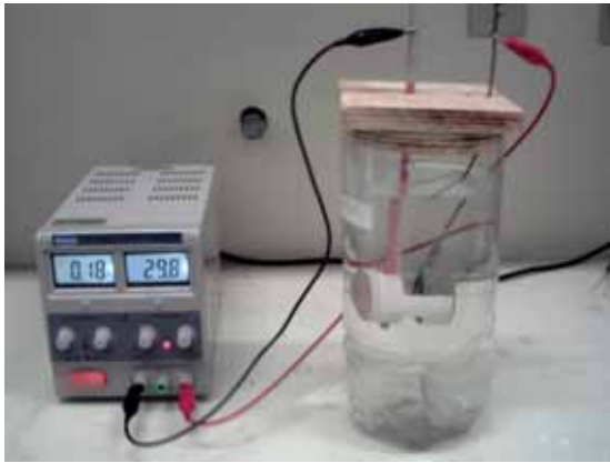
(a) Cuba PET e fonte utilizadas na anodização
