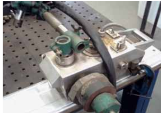
(d) Carrinho de oxicorte adaptado para avanço da tocha com regulação de velocidade.
