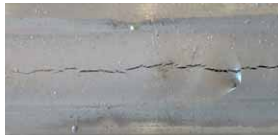
(b) Formação de pontes. (condição A1)
