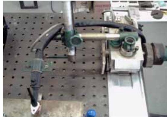
(b) Detalhe da montagem para automatização do movimento da tocha.
