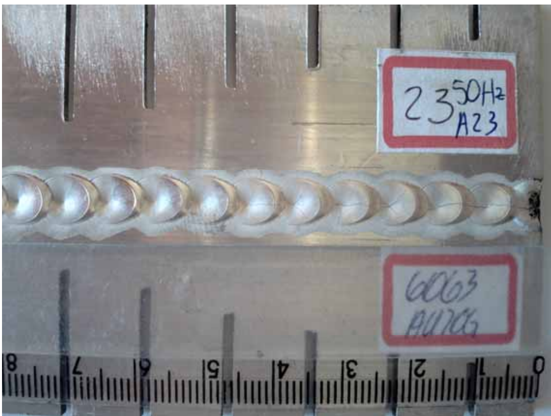
Figura 5.8- Foto da trinca. Freqüência de inversão de polaridade de 50Hz e pulso térmico de 0,5Hz.
