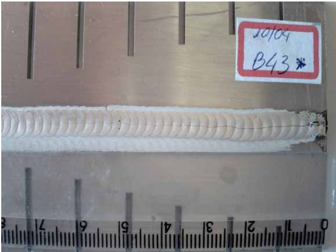
Figura 5.15- Foto da trinca. Frequência de inversão de polaridade de 100Hz e pulso térmico de 1,7Hz.
