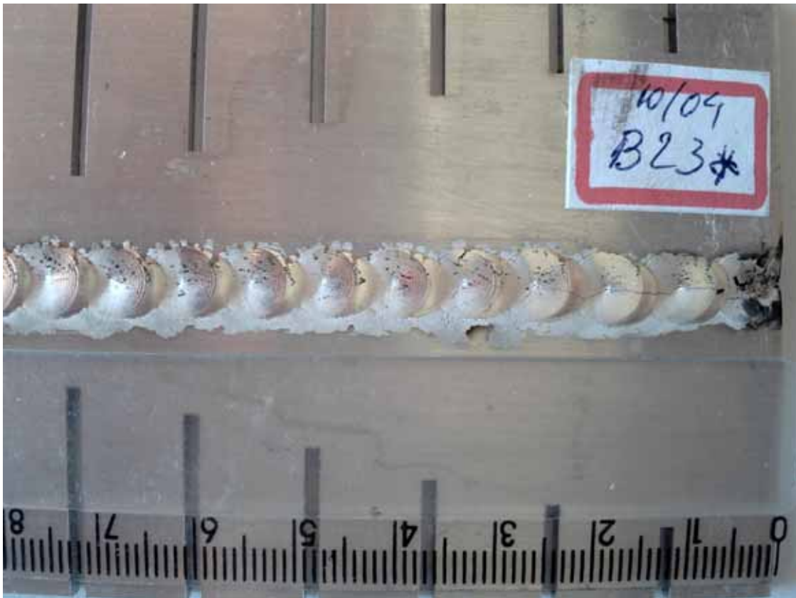
Figura 5.13- Foto da trinca. Frequência de inversão de polaridade de 100Hz e pulso térmico de 0,5Hz.
