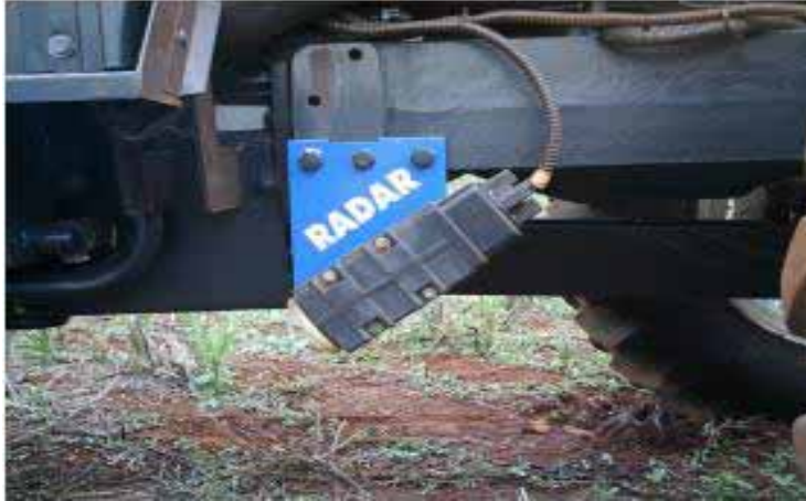
Figura 10. Radar instalado na lateral direita do trator para a determinação da velocidade real de deslocamento (LOPES, 2006).
