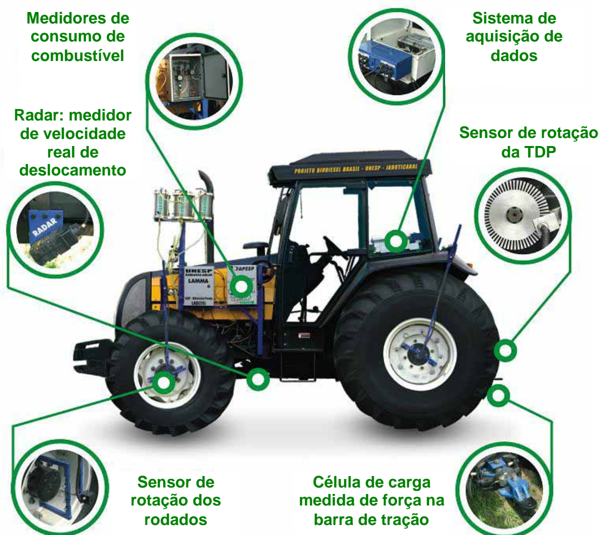
Figura 9. Protótipo e instrumentação do trator de teste para ensaio de desempenho. Fonte: LOPES, (2006).
