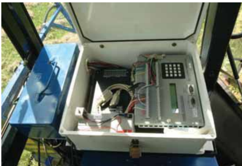
Figura 13. Micrologger CR23X montado na cabine de operação do trator. Fonte: LOPES, (2006).
