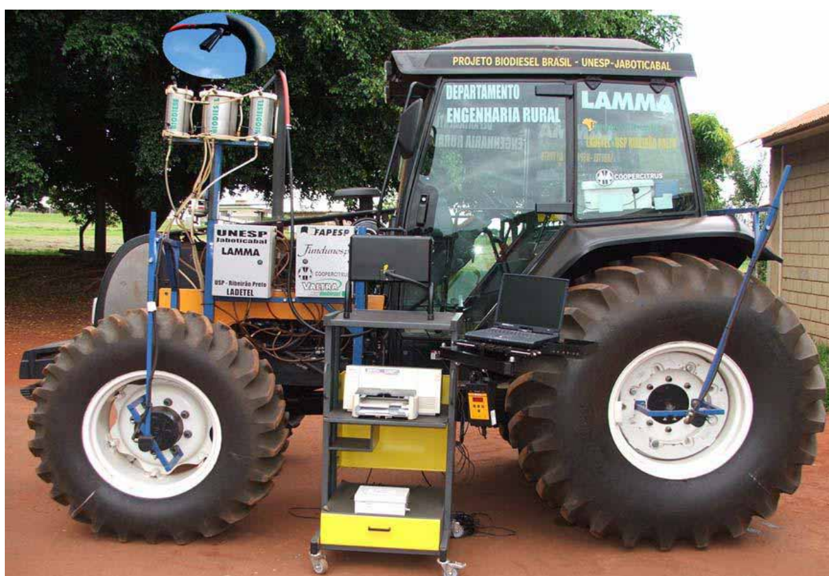
Figura 15. Vista geral do trator instrumentado para o ensaio de opacidade da fumaça Fonte: LOPES (2006).
