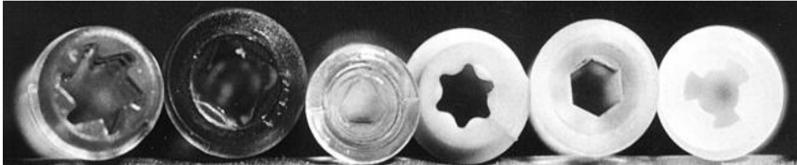
Figura 2.9: Seis parafusos bioabsorvíveis com diferentes encaixes e fabricantes: turbina (Sulzer), quadrangular (Instrument Makar), triangular (Phusis), hexalobular (Acufex), hexagonal (Arthrex) e trilobular (Linvatec).(adaptado de WEILER et al. , 1998).
