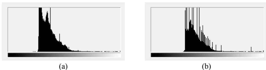
Figura 40. Comparação entre os histogramas de um recorte: (a) antes e (b) depois do matching .
