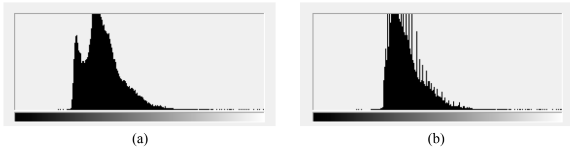
Figura 52. Comparação para um recorte de seus histogramas: (a) antes do matching e (b) depois.
