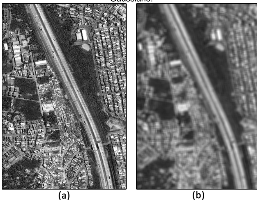
Figura 30 – Exemplo de Filtro Gaussiano. (a) Imagem Original (b) Resultado do Filtro Gaussiano.
