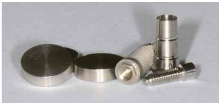
O Carbono tipo diamante recobriu as superfícies dos componentes protéticos dos implantes e dos discos de titânio testados (gentilmente doados pela empresa CVDVale que detém a patente do sistema) (Figura 2).
