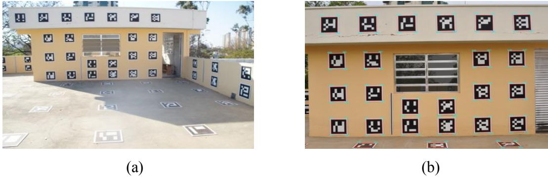
Figura 30 - (a) Campo de calibração tridimensional; (b) identificação automática dos alvos no padrão ArUco.
