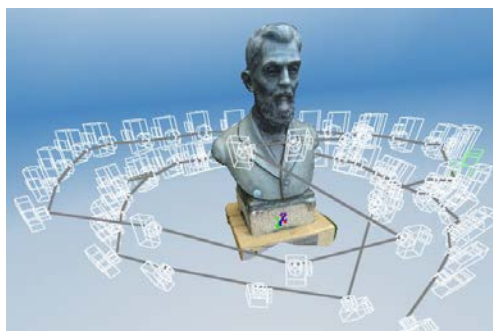
Figura 48- Modelo tridimensional e distribuição das estações para a tomada das imagens na interface do programa Autodesk 123D Catch.
