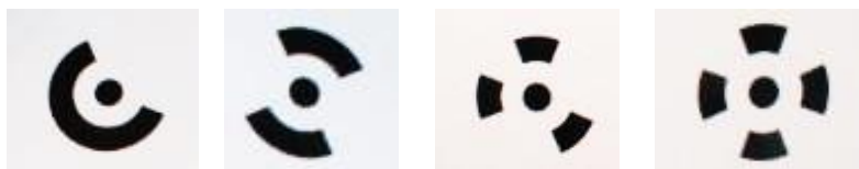
Figura 40- alvos codificados no padrão PhotoModeler para reconhecimento automático.
