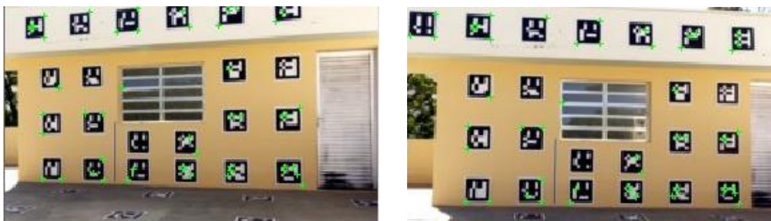
Figura 19 – Estereo-par com os pontos de passagem, controle e verificação identificados.
