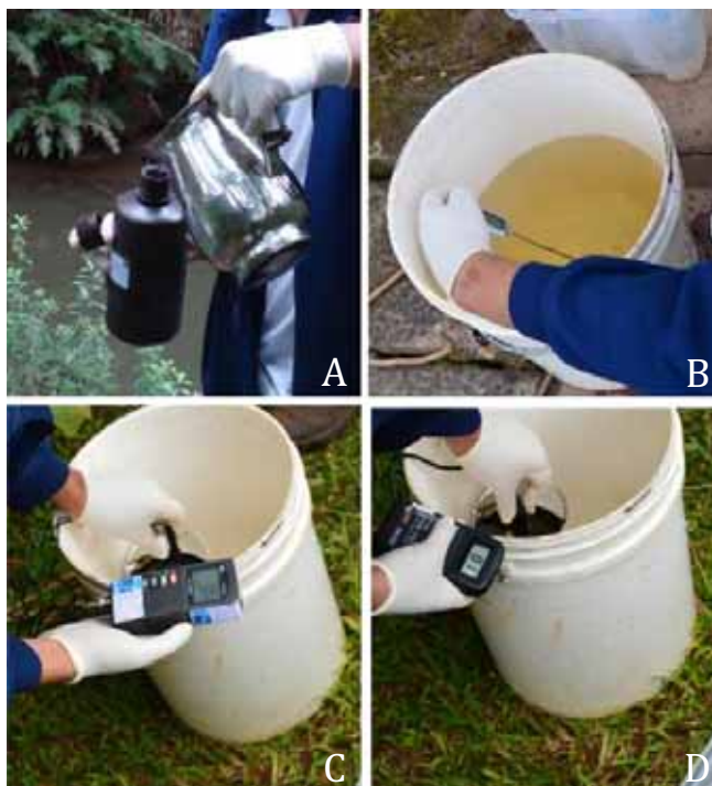
Figura 19 - Coleta de amostras de água nas bacias hidrográficas da Serra da Mantiqueira: A) frasco contendo reagente; B) termômetro 0°C a 50°C; C) equipamento multiparâmetro e D) Oxímetro - equipamento para medir oxigênio dissolvido (OD).
