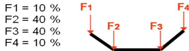
Figura 6 – Configuração da distribuição de forças nos roletes de carga.
