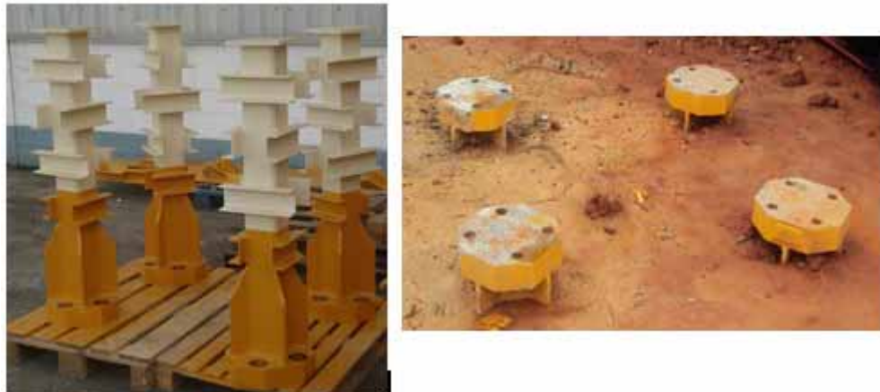
Figura 5 – Detalhe dos chumbadores antes e após serem fixados á base.
