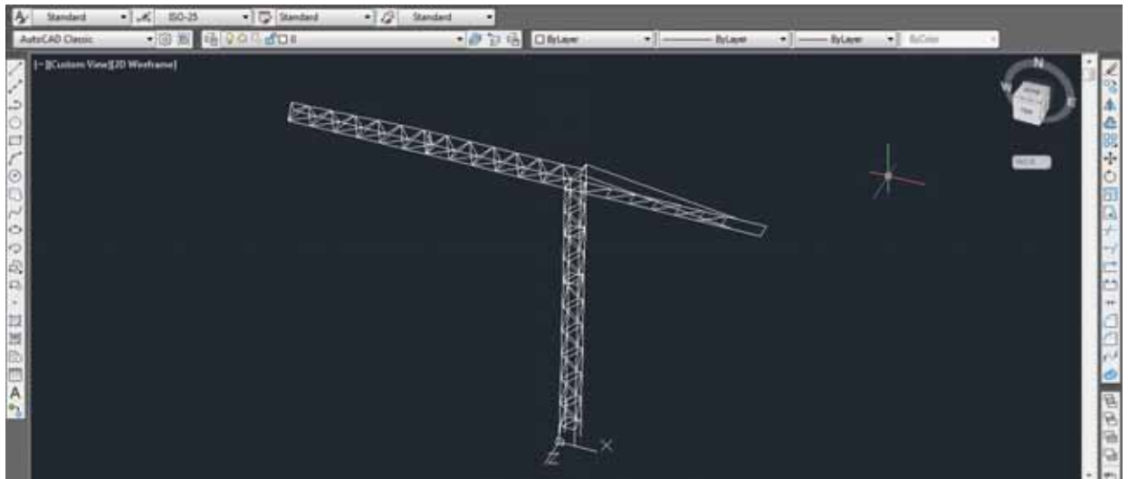
Figura 9 - Representação tridimensional do modelo matemático do guindaste de torre.
