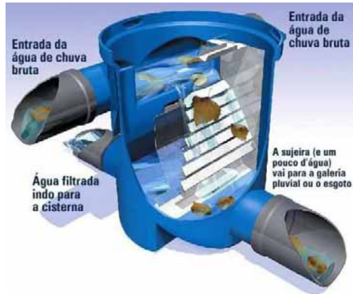
Figura 7 - Componentes internos do filtro VF1.
