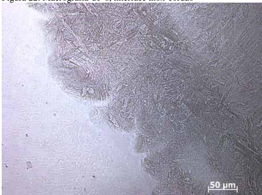
Figura 22: Macrografia CP 6, interface inox-cordão
