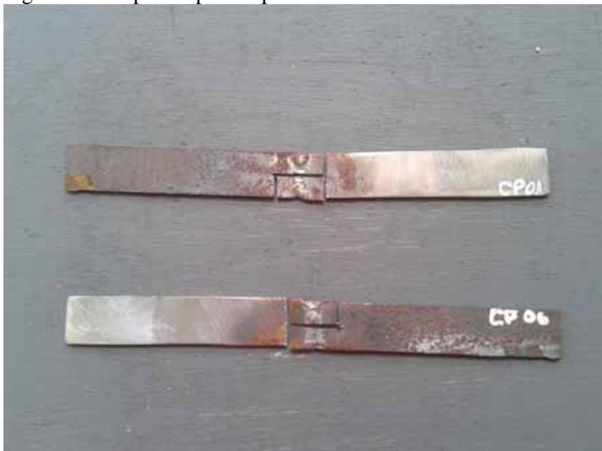
Figura 16: Corpos de prova após corte da serra fita
