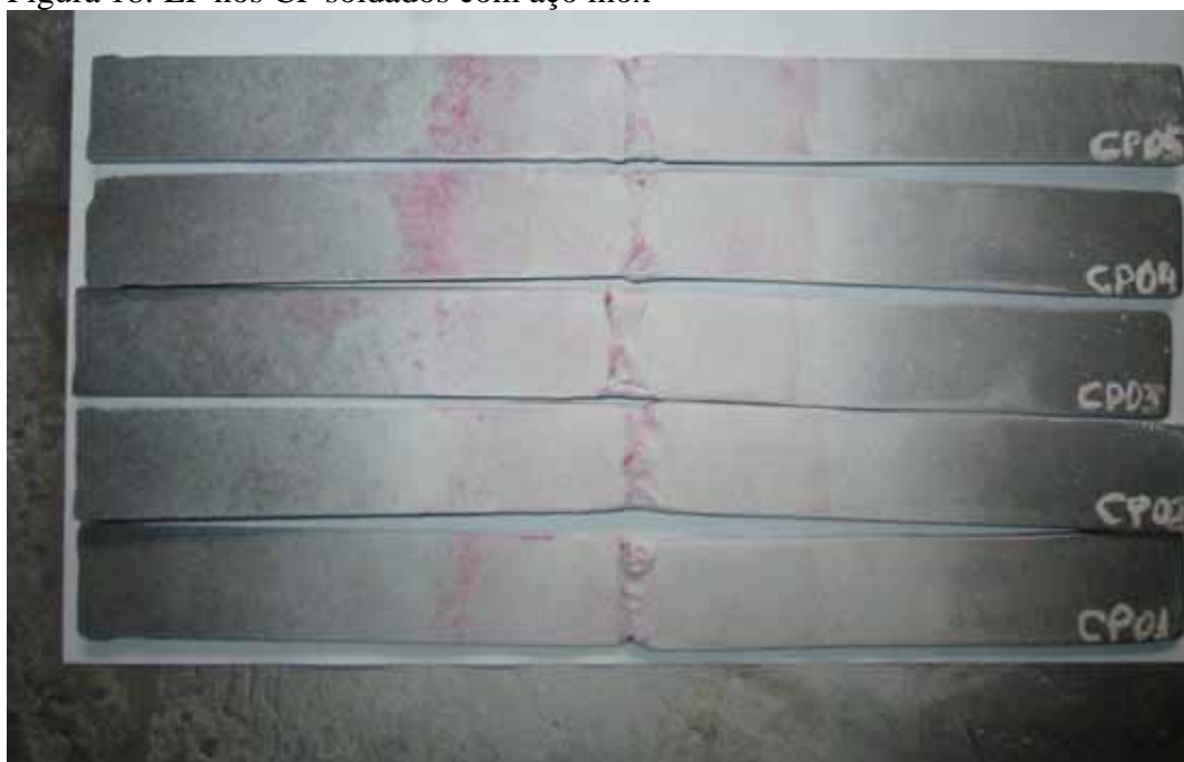
Figura 18: LP nos CP soldados com aço inox
