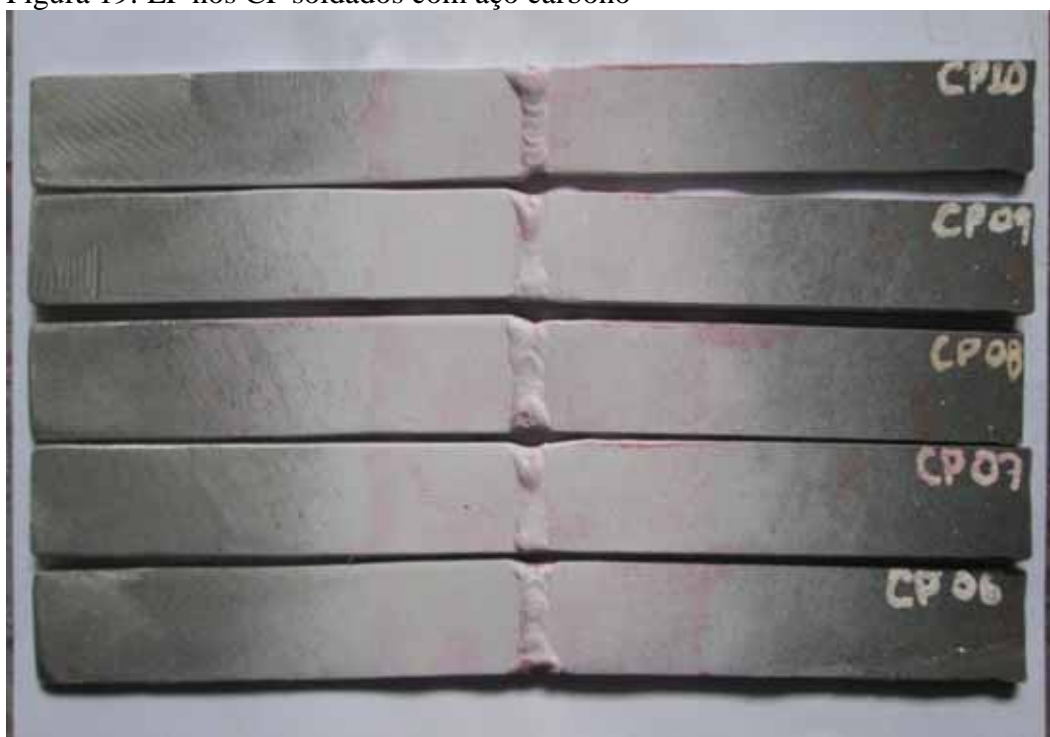
Figura 19: LP nos CP soldados com aço carbono
