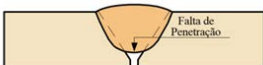
Figura 9: Ilustração da falta de penetração
