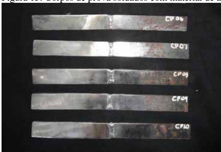
Figura 15: Corpos de prova soldados com material de adição de aço carbono
