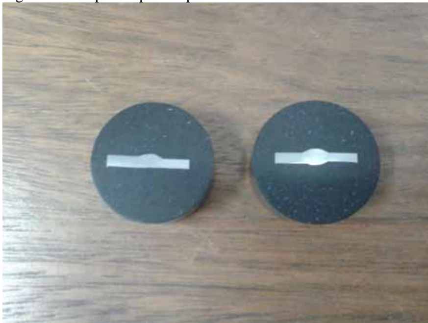
Figura 17: Corpos de prova após embutimento e lixamento.
