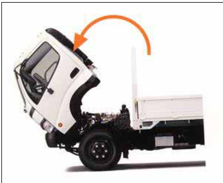
Figura 8 – O mecanismo de cabine basculante.
