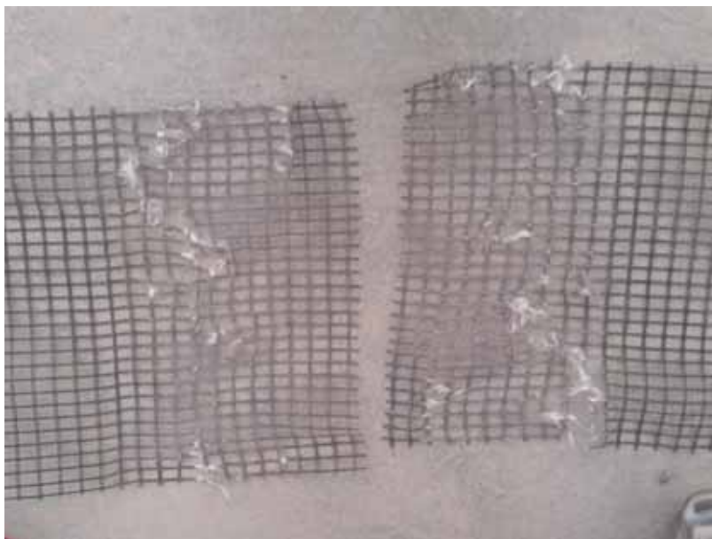
Figura 435 - Geogrelha Modelo Fortrac® M 80/30-20 Camada Dupla Sobrecarga de 50 kPa (Ensaio 2)
