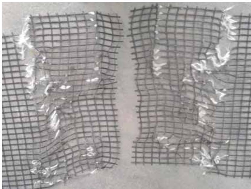
Figura 472 - Geogrelha Modelo Fortrac® M 110/30-20 Camada Dupla Sobrecarga de 85 kPa (Ensaio 3)
