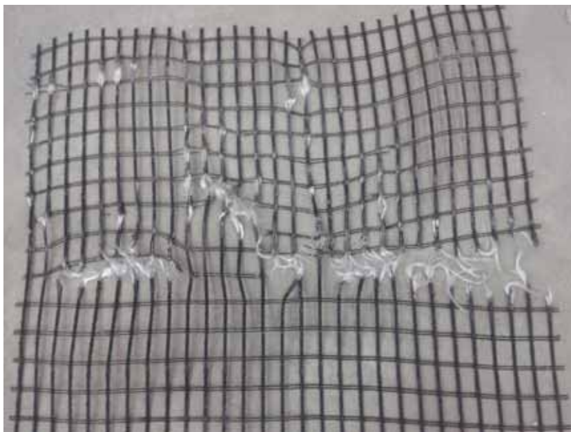
Figura 458 - Geogrelha Modelo Fortrac® M 110/30-20 Camada Simples Sobrecarga de 100 kPa (Ensaio 1)
