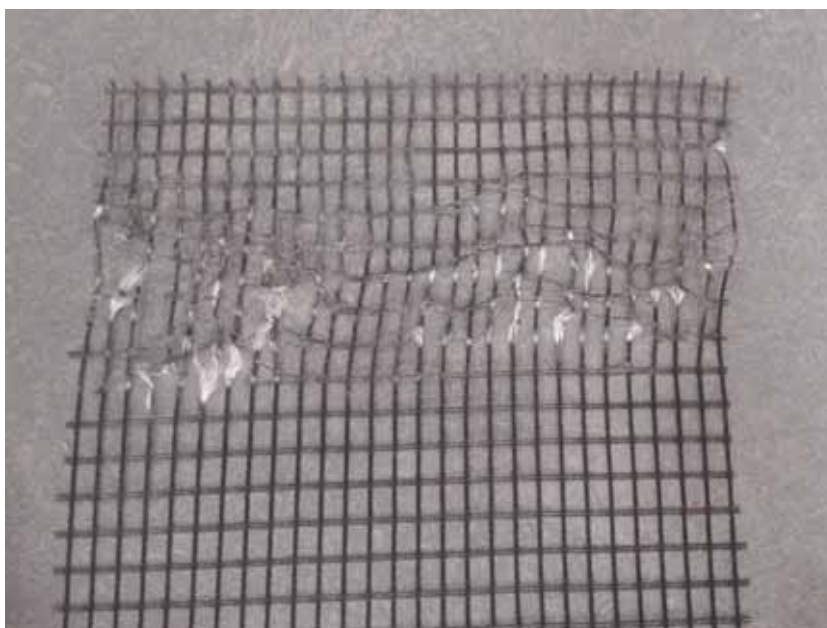
Figura 414 - Geogrelha Modelo Fortrac® M 80/30-20 Camada Simples Sobrecarga de 18 kPa (Ensaio 1)
