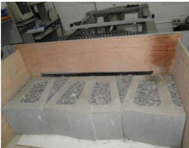
Figura 20 – Primeiro segmento de blocos montados e preenchidos com brita 1
