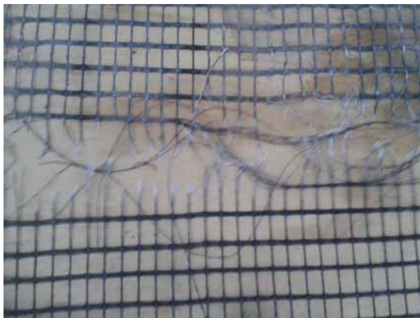
Figura 346 - Geogrelha Modelo Fortrac® M 35/20-20 Camada Simples Sobrecarga de 35 kPa (Ensaio 2)
