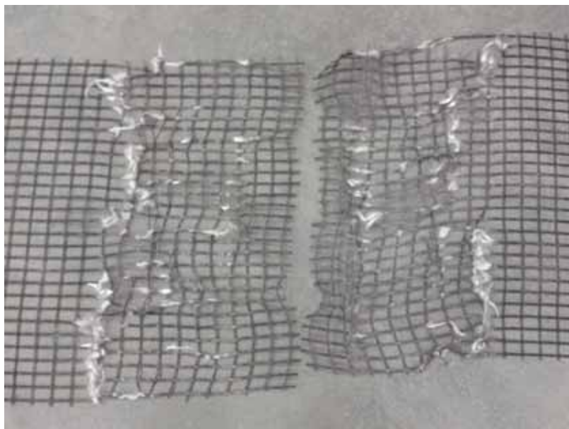
Figura 475 - Geogrelha Modelo Fortrac® M 110/30-20 Camada Dupla Sobrecarga de 100 kPa (Ensaio 3)
