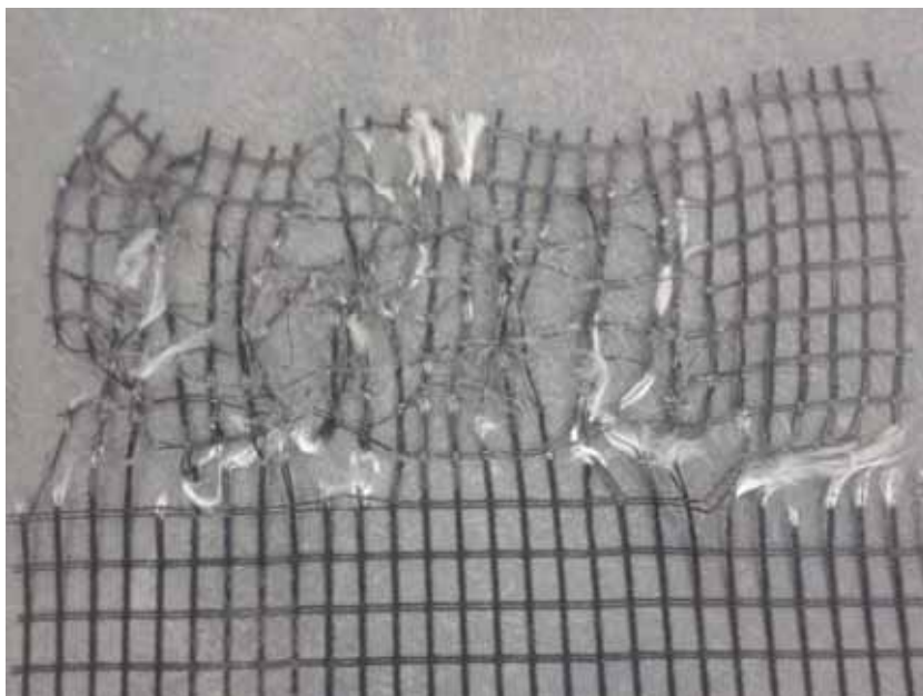
Figura 454 - Geogrelha Modelo Fortrac® M 110/30-20 Camada Simples Sobrecarga de 70 kPa (Ensaio 3)
