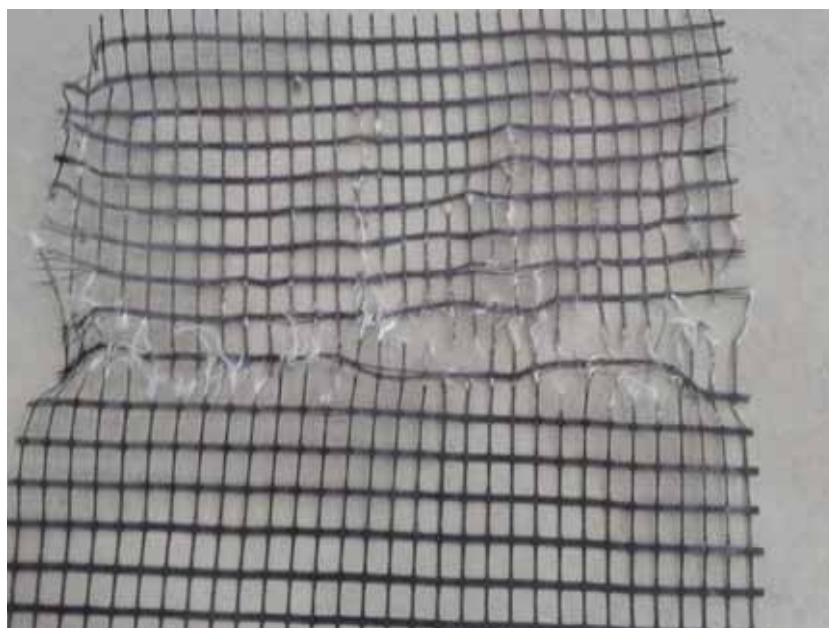
Figura 384 - Geogrelha Modelo Fortrac® M 55/30-20 Camada Simples Sobrecarga de 50 kPa (Ensaio 1)
