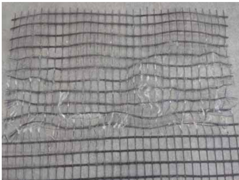
Figura 341 - Geogrelha Modelo Fortrac® M 35/20-20 Camada Simples Sobrecarga de 3 kPa (Ensaio 3)
