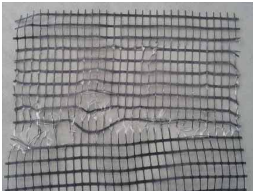
Figura 393 - Geogrelha Modelo Fortrac® M 55/30-20 Camada Simples Sobrecarga de 100 kPa (Ensaio 1)
