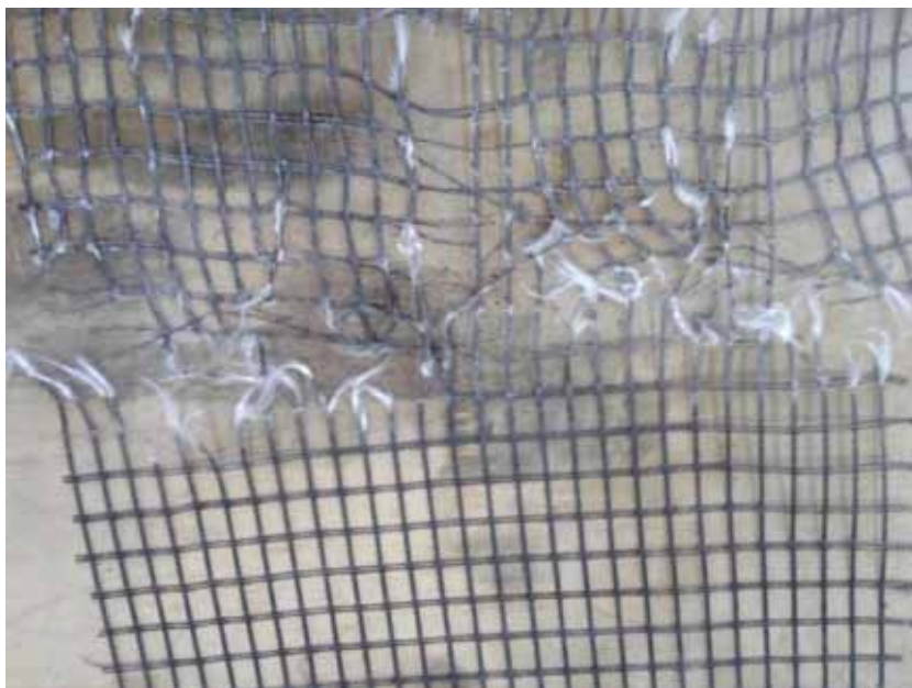
Figura 423 - Geogrelha Modelo Fortrac® M 80/30-20 Camada Simples Sobrecarga de 70 kPa (Ensaio 1)
