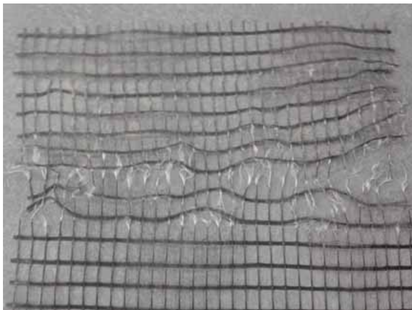
Figura 339 - Geogrelha Modelo Fortrac® M 35/20-20 Camada Simples Sobrecarga de 3 kPa (Ensaio 1)
