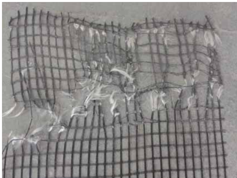
Figura 452 - Geogrelha Modelo Fortrac® M 110/30-20 Camada Simples Sobrecarga de 70 kPa (Ensaio 1)
