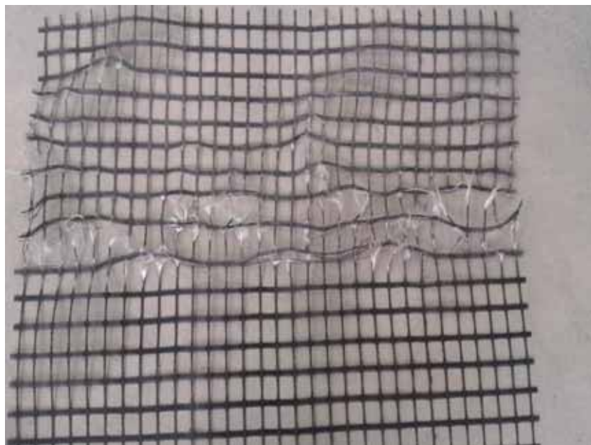
Figura 379 - Geogrelha Modelo Fortrac® M 55/30-20 Camada Simples Sobrecarga de 18 kPa (Ensaio 2)
