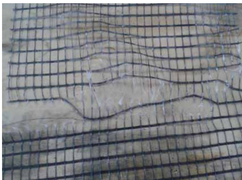
Figura 352 - Geogrelha Modelo Fortrac® M 35/20-20 Camada Simples Sobrecarga de 70 kPa (Ensaio 2)
