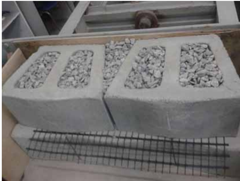
Figura 23 - Disposição finalizada do segundo segmento de blocos
