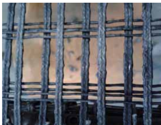
Figura 3 - Exemplo de Geogrelha de PVA
