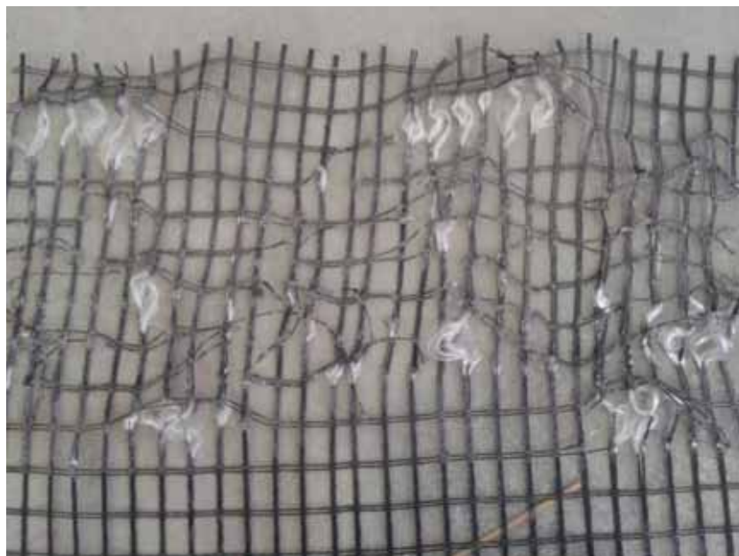
Figura 448 - Geogrelha Modelo Fortrac® M 110/30-20 Camada Simples Sobrecarga de 35 kPa (Ensaio 3)
