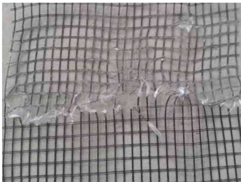
Figura 424 - Geogrelha Modelo Fortrac® M 80/30-20 Camada Simples Sobrecarga de 70 kPa (Ensaio 2)
