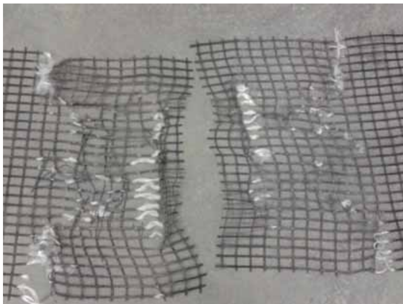
Figura 474 - Geogrelha Modelo Fortrac® M 110/30-20 Camada Dupla Sobrecarga de 100 kPa (Ensaio 2)
