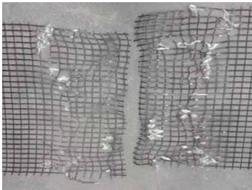
Figura 468 - Geogrelha Modelo Fortrac® M 110/30-20 Camada Dupla Sobrecarga de 70 kPa (Ensaio 2)
