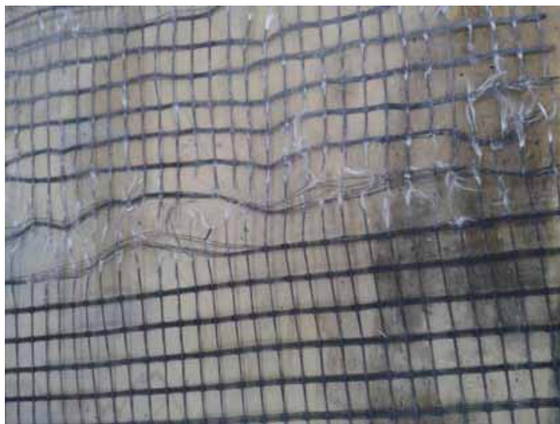
Figura 348 - Geogrelha Modelo Fortrac® M 35/20-20 Camada Simples Sobrecarga de 50 kPa (Ensaio 1)
