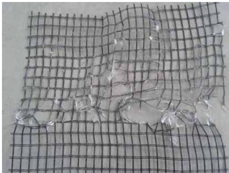
Figura 431 -Geogrelha Modelo Fortrac® M 80/30-20 Camada Simples Sobrecarga de 100 kPa (Ensaio 3)
