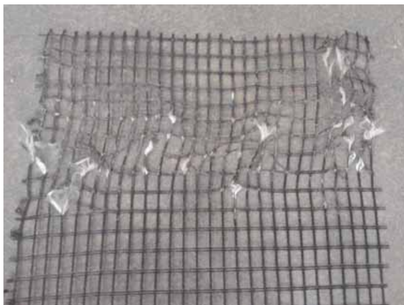
Figura 416 - Geogrelha Modelo Fortrac® M 80/30-20 Camada Simples Sobrecarga de 18 kPa (Ensaio 3)
