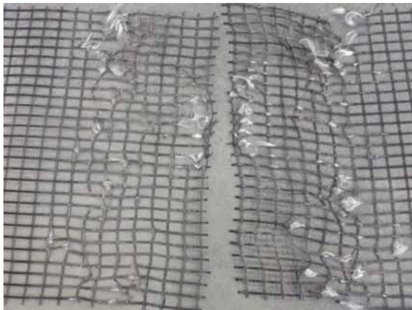
Figura 463 - Geogrelha Modelo Fortrac® M 110/30-20 Camada Dupla Sobrecarga de 35 kPa (Ensaio 3)
