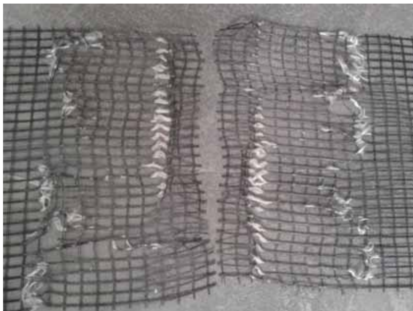
Figura 470 - Geogrelha Modelo Fortrac® M 110/30-20 Camada Dupla Sobrecarga de 85 kPa (Ensaio 1)
