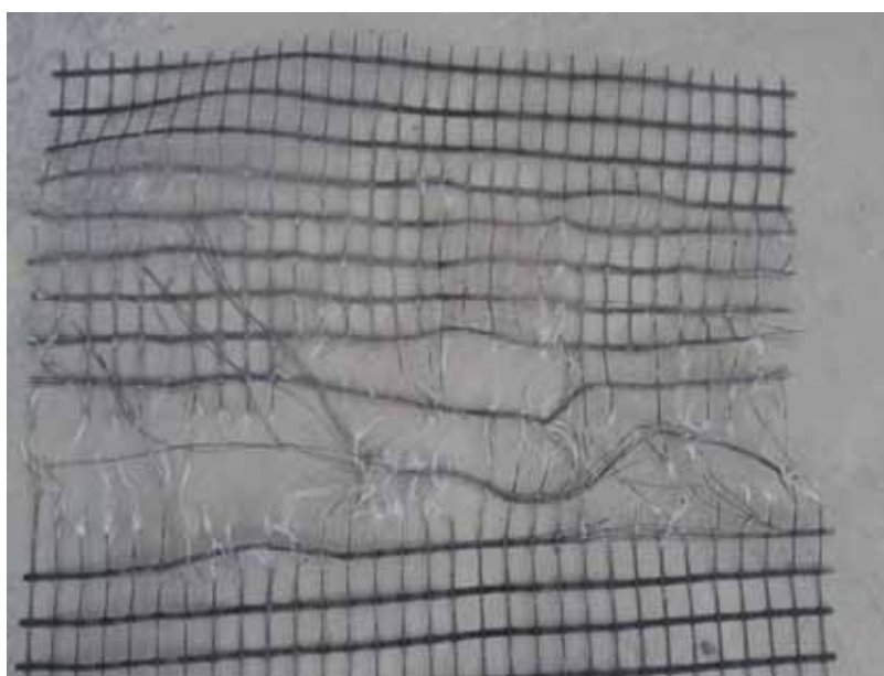
Figura 358 - Geogrelha Modelo Fortrac® M 35/20-20 Camada Simples Sobrecarga de 100 kPa (Ensaio 2)
