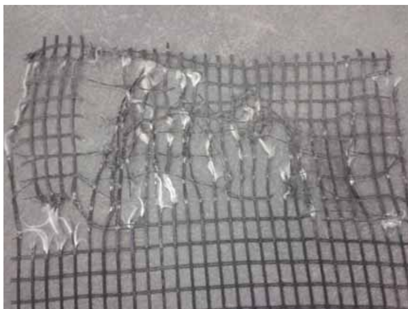
Figura 453 - Geogrelha Modelo Fortrac® M 110/30-20 Camada Simples Sobrecarga de 70 kPa (Ensaio 2)
