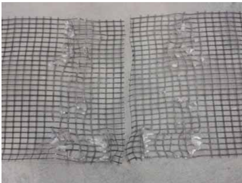
Figura 433 - Geogrelha Modelo Fortrac® M 80/30-20 Camada Dupla Sobrecarga de 35 kPa (Ensaio 2)
