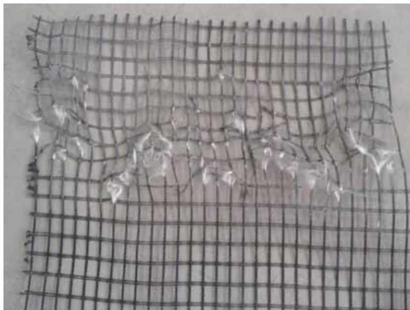
Figura 415 - Geogrelha Modelo Fortrac® M 80/30-20 Camada Simples Sobrecarga de 18 kPa (Ensaio 2)
