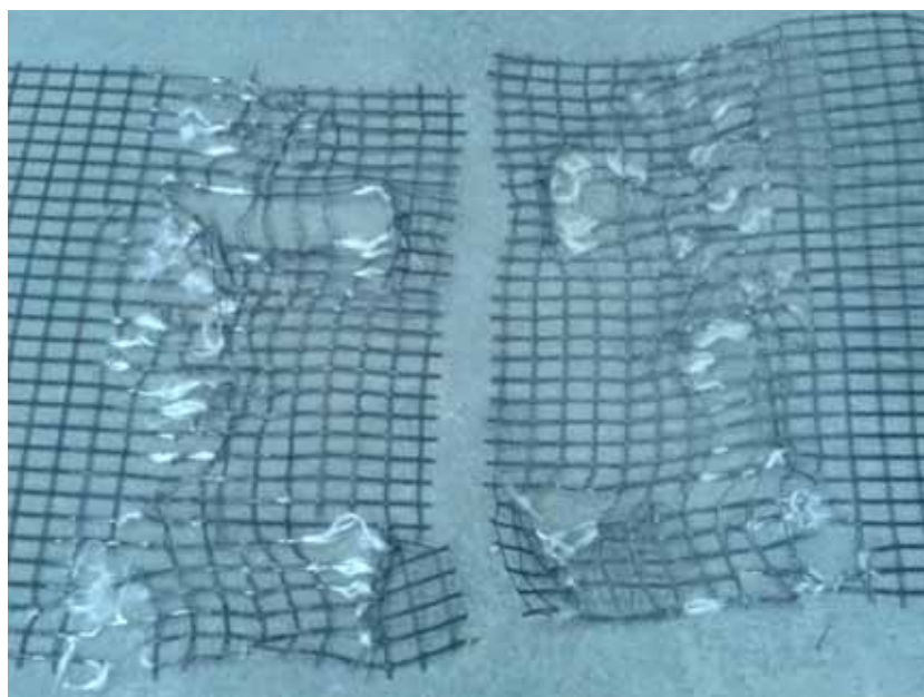
Figura 466 - Geogrelha Modelo Fortrac® M 110/30-20 Camada Dupla Sobrecarga de 50 kPa (Ensaio 3)
