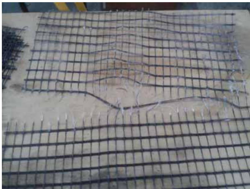
Figura 345 - Geogrelha Modelo Fortrac® M 35/20-20 Camada Simples Sobrecarga de 35 kPa (Ensaio 1)
