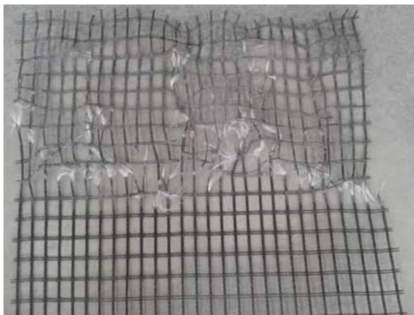
Figura 420 - Geogrelha Modelo Fortrac® M 80/30-20 Camada Simples Sobrecarga de 50 kPa (Ensaio 1)
