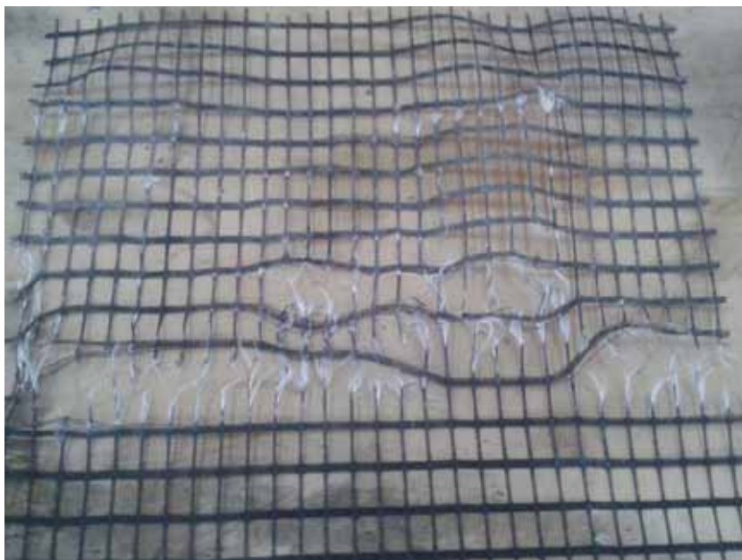
Figura 381 - Geogrelha Modelo Fortrac® M 55/30-20 Camada Simples Sobrecarga de 35 kPa (Ensaio 1)
