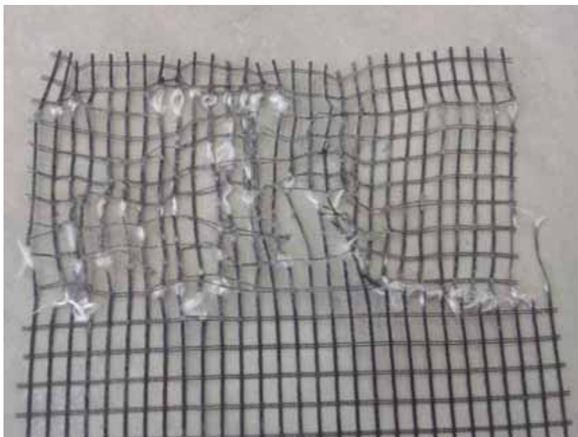
Figura 450 - Geogrelha Modelo Fortrac® M 110/30-20 Camada Simples Sobrecarga de 50 kPa (Ensaio 2)
