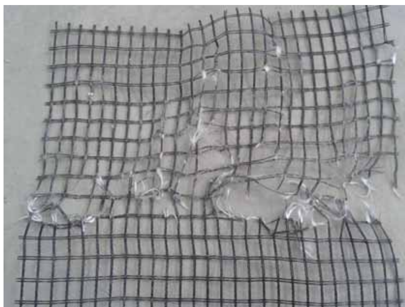
Figura 418 - Geogrelha Modelo Fortrac® M 80/30-20 Camada Simples Sobrecarga de 35 kPa (Ensaio 2)
