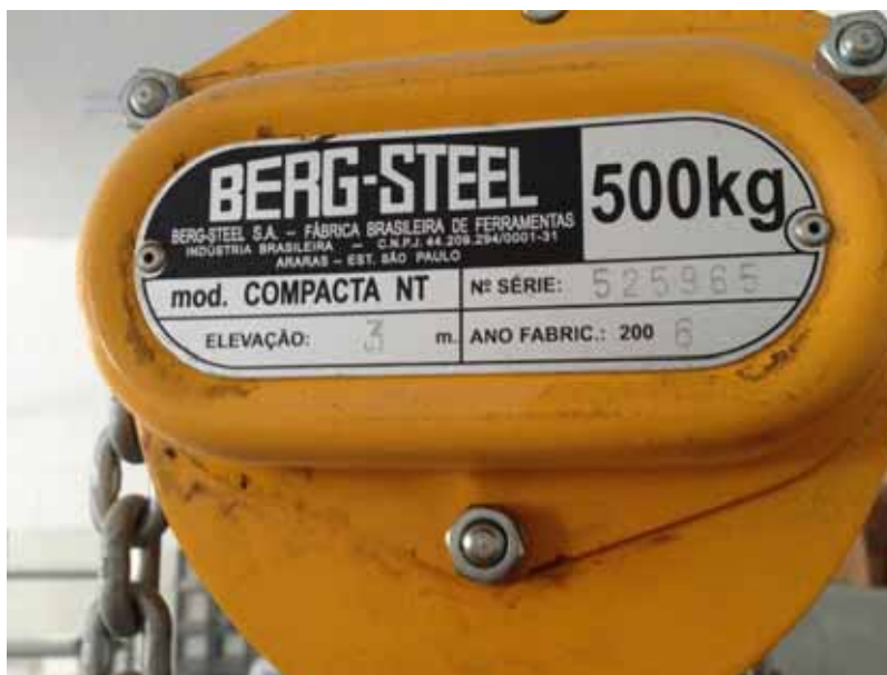
Figura 18 - Especificações da talha modelo COMPACTA NT da empresa Berg-Steel S.A.
