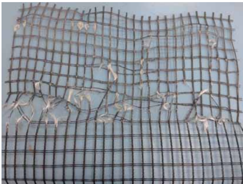
Figura 421 - Geogrelha Modelo Fortrac® M 80/30-20 Camada Simples Sobrecarga de 50 kPa (Ensaio 2)
