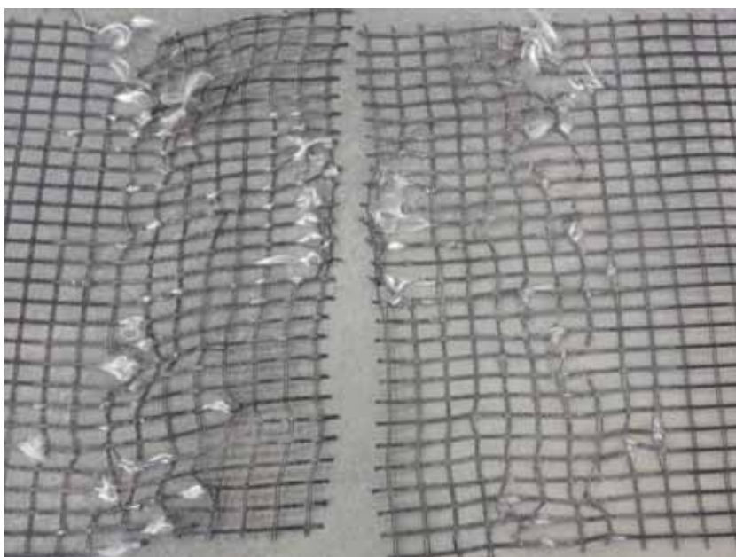
Figura 461 - Geogrelha Modelo Fortrac® M 110/30-20 Camada Dupla Sobrecarga de 35 kPa (Ensaio 1)
