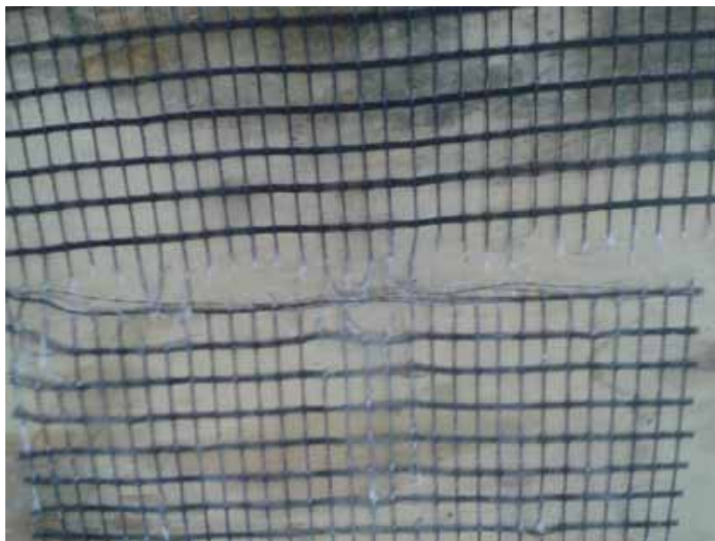
Figura 351 - Geogrelha Modelo Fortrac® M 35/20-20 Camada Simples Sobrecarga de 70 kPa (Ensaio 1)
