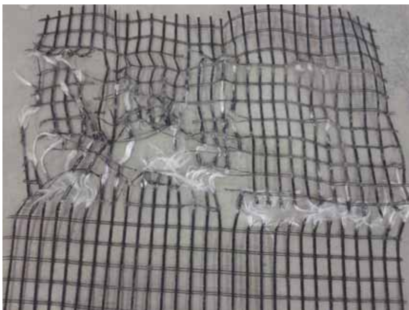
Figura 459 - Geogrelha Modelo Fortrac® M 110/30-20 Camada Simples Sobrecarga de 100 kPa (Ensaio 2)
