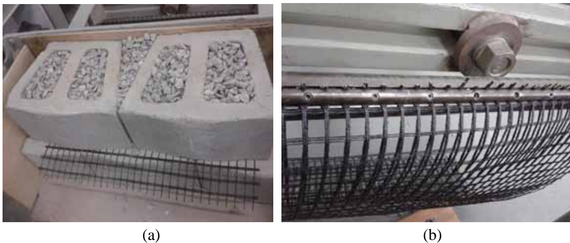
Figura 13 - (a) Disposição da geogrelha entre os blocos segmentais de concreto (b) Garra da prensa mecânica horizontal.
