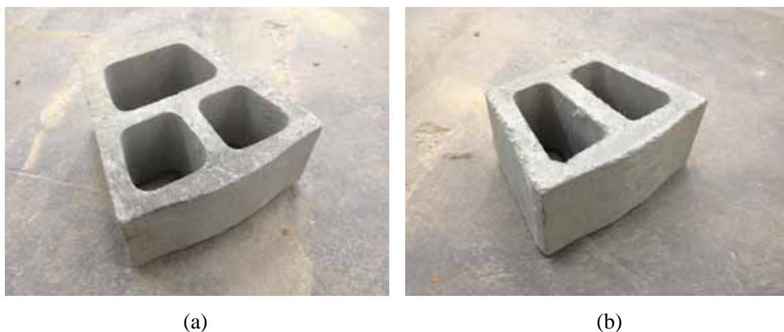
Figura 37 - (a) Bloco modelo W utilizado por Guimarães (2006) (b) Bloco modelo MW utilizado no presente trabalho (2015)
