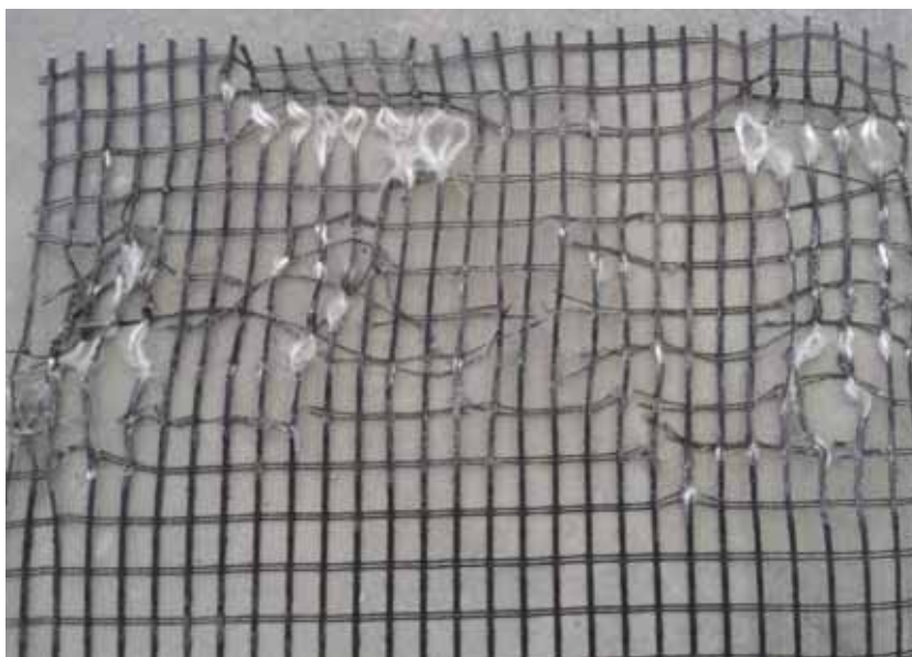
Figura 447 - Geogrelha Modelo Fortrac® M 110/30-20 Camada Simples Sobrecarga de 35 kPa (Ensaio 2)
