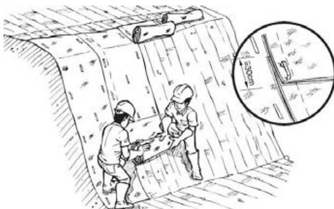
Figura 12: Posicionamento da geomanta, transpasses e ancoragem, conforme recomendação de fabricantes.
