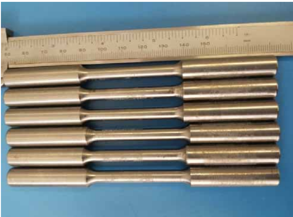
Figura 17: Imagem dos corpos de prova utilizados no ensaio de tração
