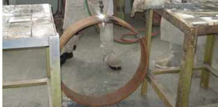
Figura 13: Processo de oxicorte em um anel de tubo.
