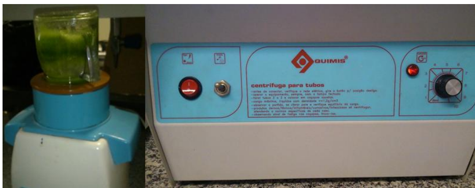
Figura 9: Extração de fenólicos totais utilizando liquidificador invertido e centrífuga para tubos
