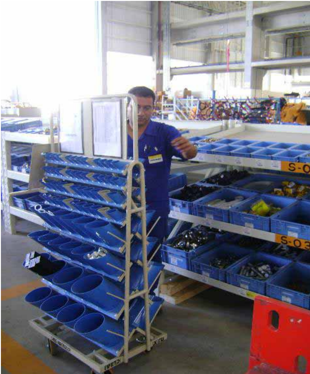
Figura 17 – Processo de abastecimento do carro de distribuição
