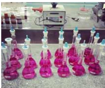
**Figura 3.** Ilustração dos pontos da curva de calibração de nitrito de sódio (0,3 a 1,1 mg/L), em triplicata.
