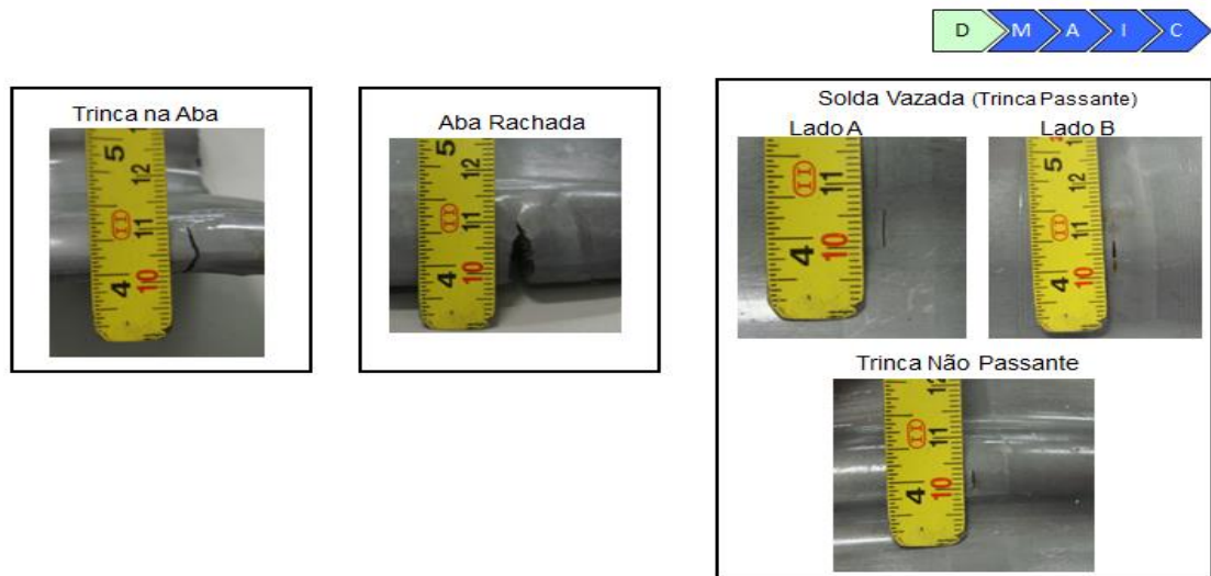
Figura 5 - Segregação de defeitos
