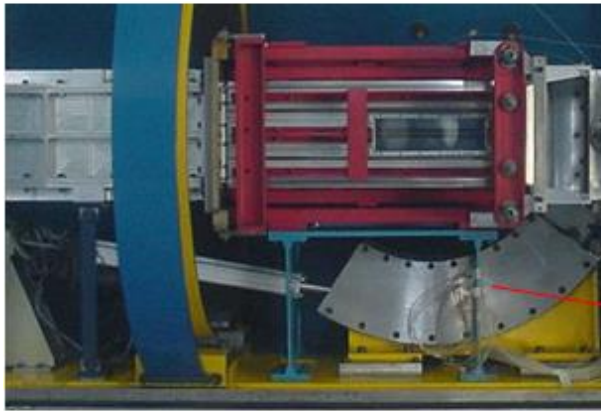
Figura 8 - Dispositivo de fixação do modelo (Seção de teste do TTP).
