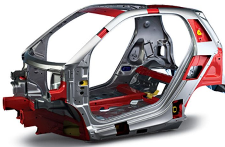
Figura 1 – Estrutura do carro Smart ForTwo 2014, com destaque para os aços multifásicos.
