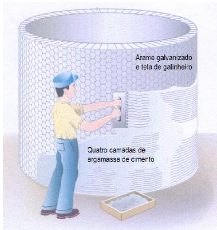
Figura 20: Cisterna de concreto com tela de arame.
