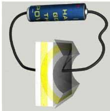
Figura 4 – Efeito piezelétrico inverso.
