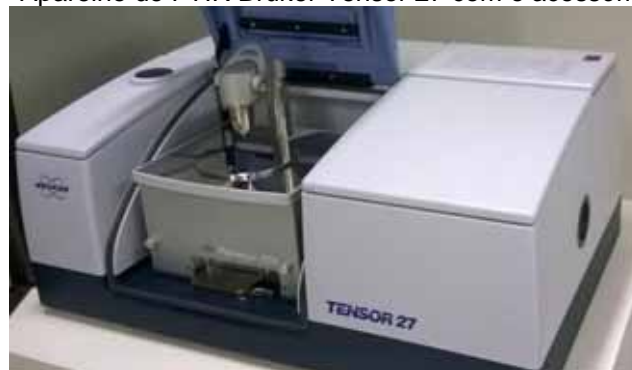
Figura 6 - Aparelho de FTIR Bruker Tensor 27 com o acessório de ATR.
