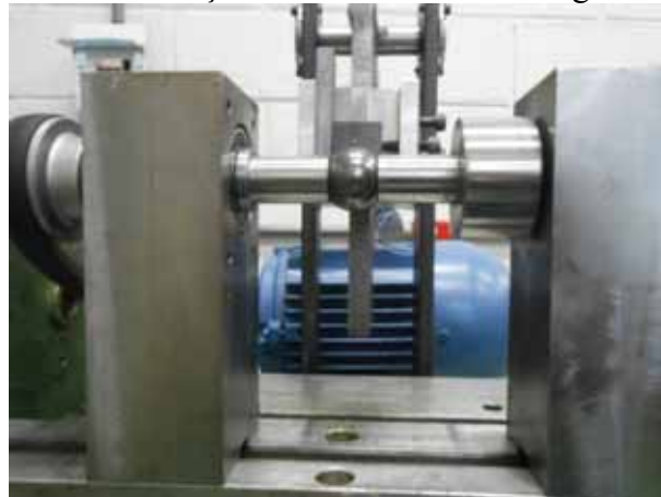
Figura 17 – Detalhe da esfera de aço durante o ensaio de desgaste.
