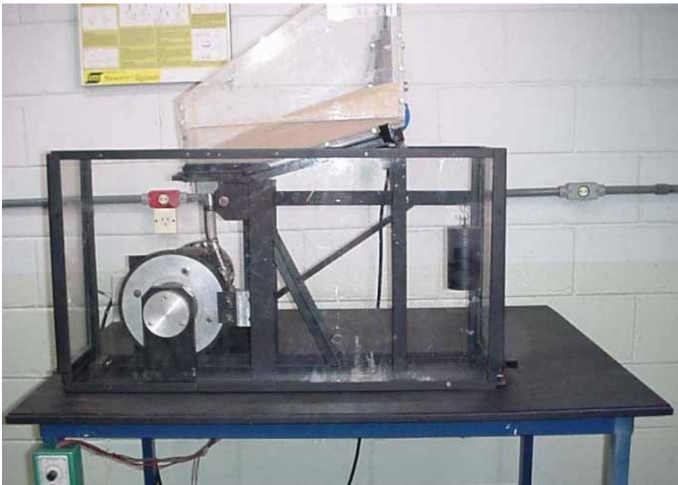
Figura 4 – Equipamento de roda de borracha e areia seca para ensaios abrasivos.
