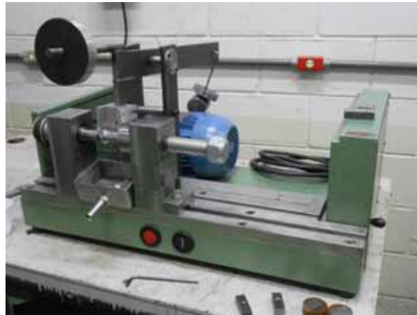
Figura 16 – Equipamento de micro desgaste por esfera rotativa para os ensaios abrasivos.
