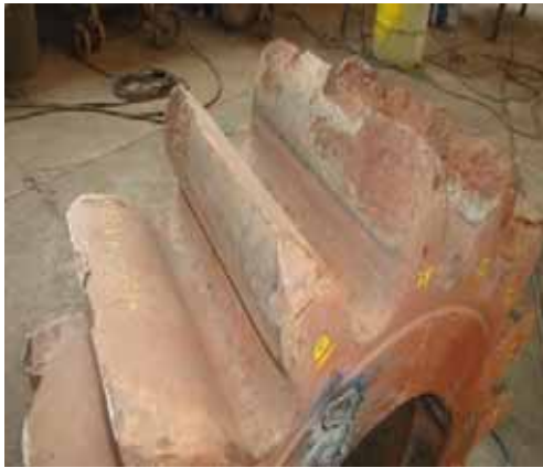
Figura 2 – Rodete de moenda de cana. a) Desgastado; b) Recuperado.
