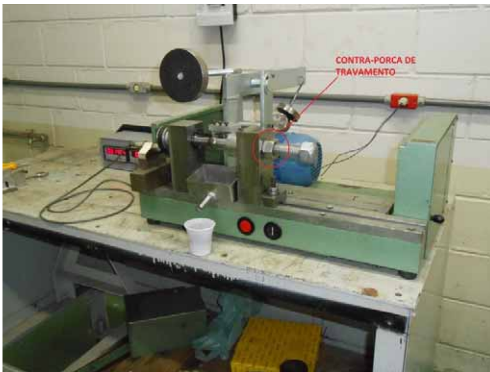
Figura 29 – Correções feitas no equipamento: contra porca.
