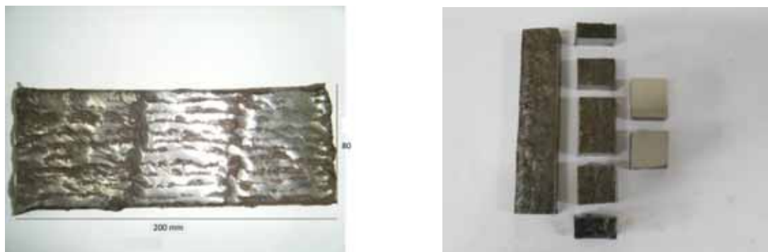
Figura 19 - Detalhe das amostras depois do corte e retifica.
