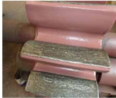
Figura 2 – Rodete de moenda de cana. a) Desgastado; b) Recuperado.
