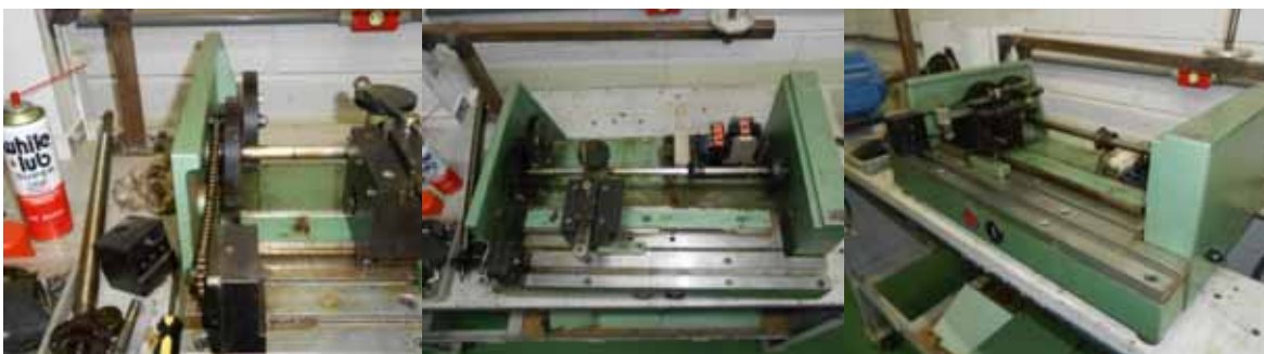
Figura 22 – Remoção dos componentes para limpeza e avaliação.
