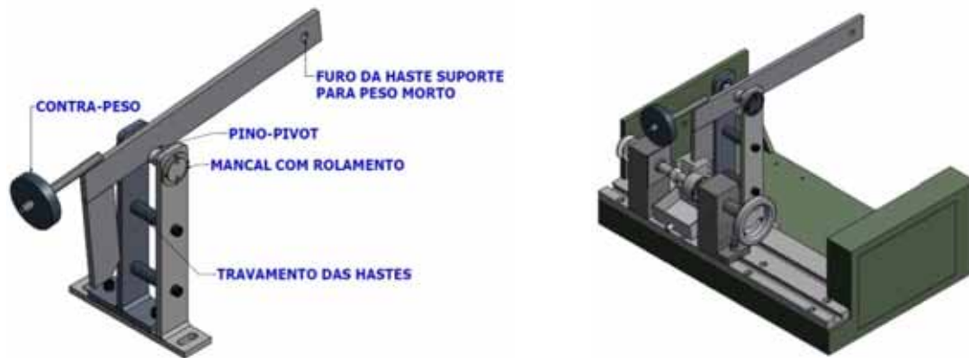
Figura 26 – Alteração do conjunto de porta amostra para aumentar a rigidez.
