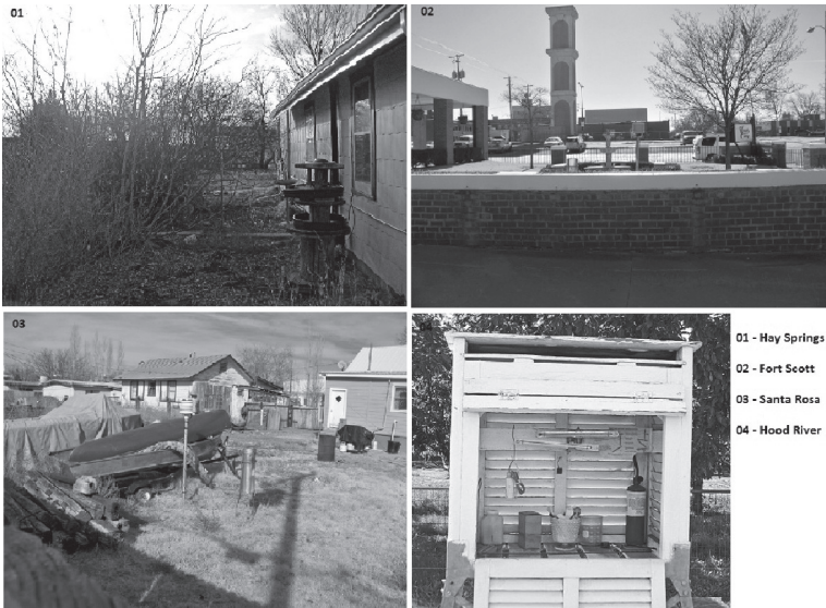
Figura 12 – Representação da má localização das estações meteorológicas do tipo Minimum Maximum Temperature Sensor (MMT) da base de dados NOAA
