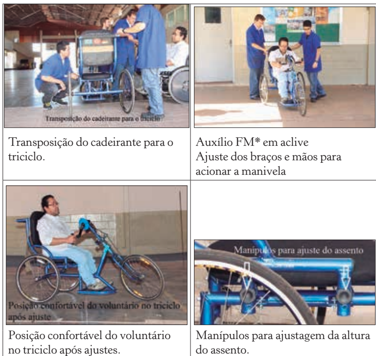
Figura 2 – Entrada do cadeirante no triciclo, ajuste da distância dos braços para acionar a manivela e o controle fino do ajuste da altura do assento como indicado nas figuras. Pega intermediária na manivela entre a pronação e a supinação.
