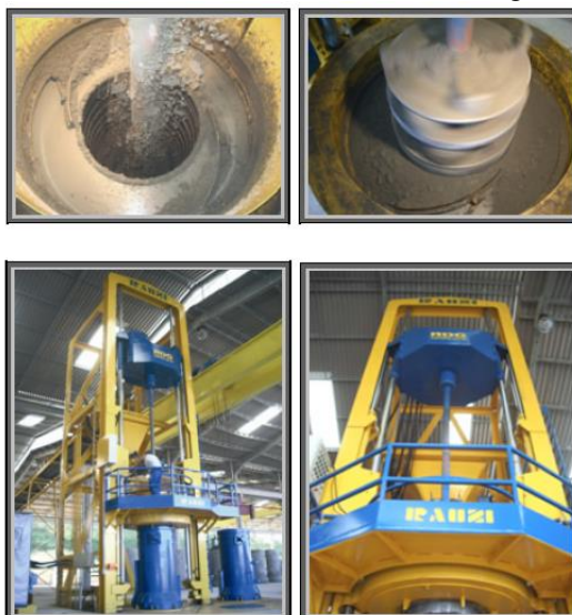
Figura 2.10 – Processo de adensamento através de giro de compressão axial
