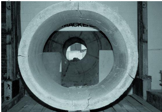
Figura 2.6 – Fissuração do Tubo
