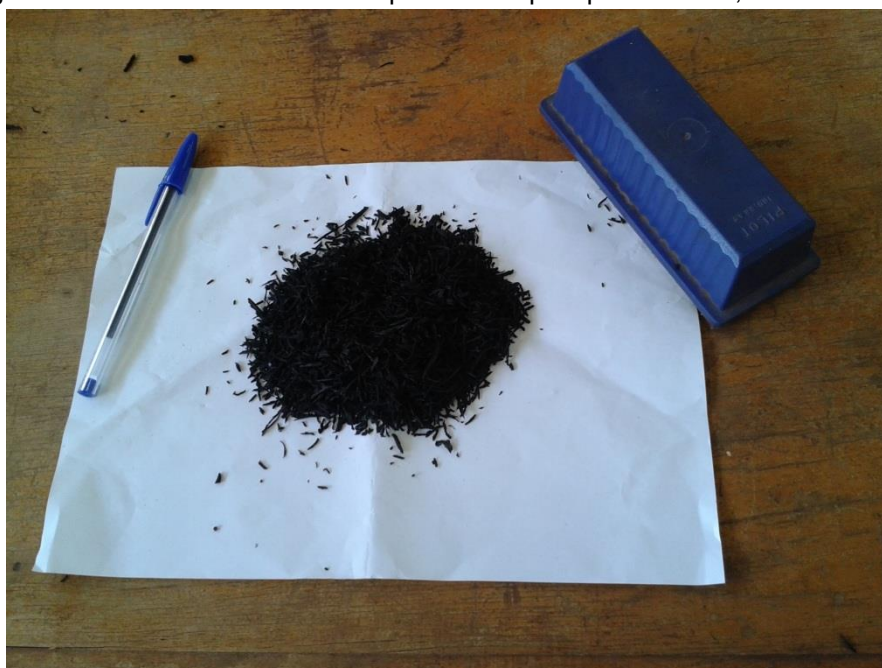
Figura 3.5 – Resíduo de borracha que é retido pela peneira de 2,38 mm de abertura
