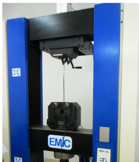
Figura 3.9 – Equipamento utilizado para o ensaio de tração das armaduras
