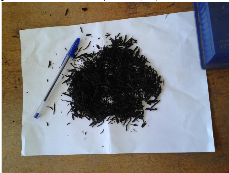
Figura 3.4 – Resíduo de borracha que é retida pela peneira de 6,3 mm de abertura
