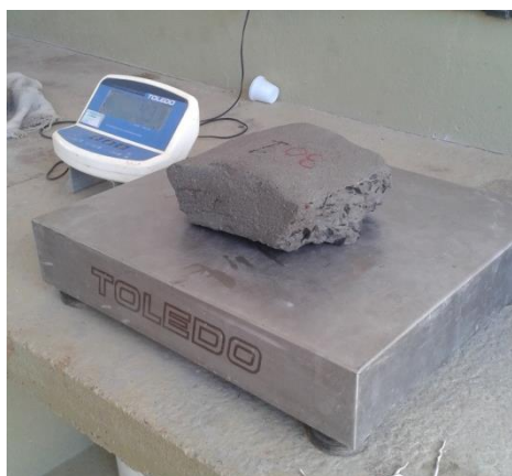
Figura 3.32 – Corpos de prova extraído do tubo após o ensaio de compressão diametral
