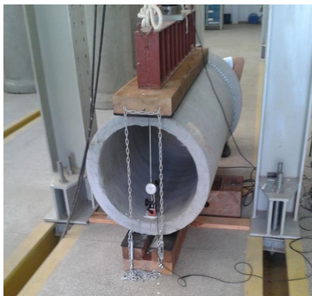
Figura 3.29 – Detalhe do posicionamento do relógio comparador na ponta
