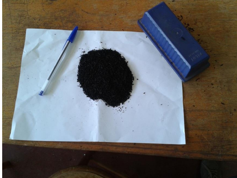
Figura 3.6 – Resíduo de borracha que é retida pela peneira de 1,19 mm de abertura
