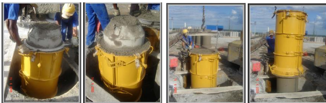
Figura 2.11 – Processo de adensamento através de compactação do tubo por meio de vibração do molde central
