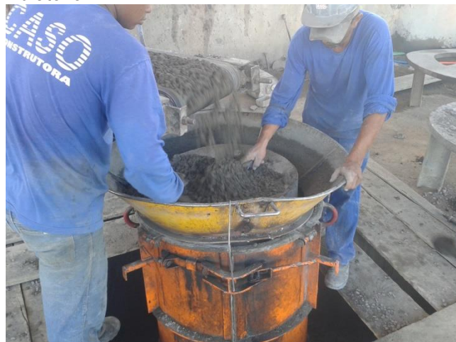
Figura 3.23 – Lançamento do concreto no núcleo vibratório
