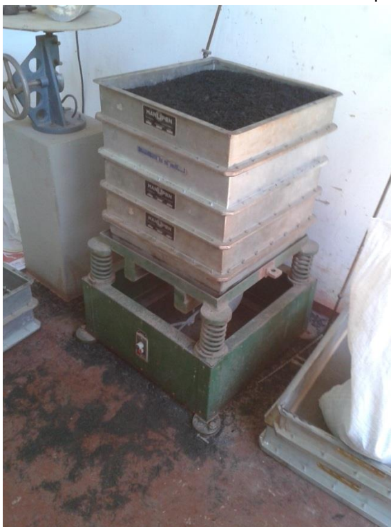
Figura 3.3 – Peneiramento do resíduo de borracha de pneu
