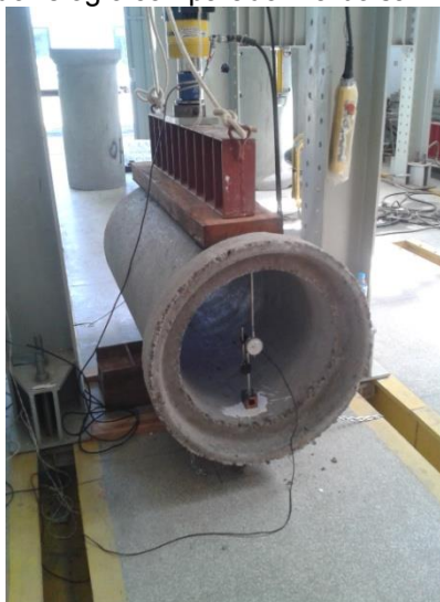
Figura 3.30 – Detalhe da colocação do relógio comparador na bolsa
