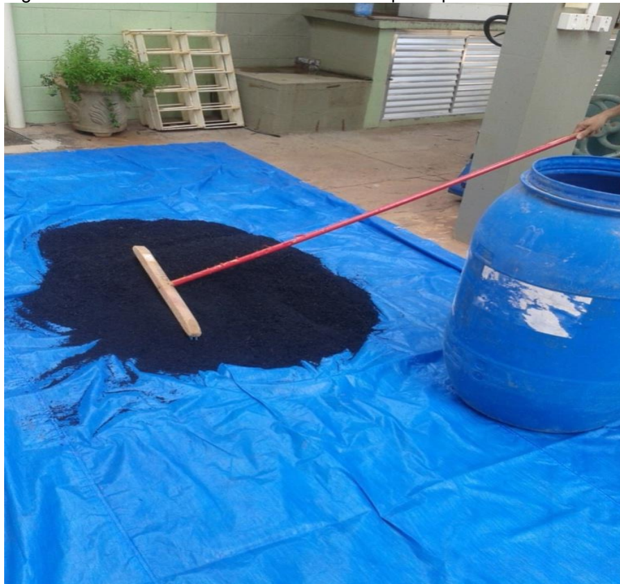
Figura 3.7 – Processo de mistura do resíduo após o peneiramento
